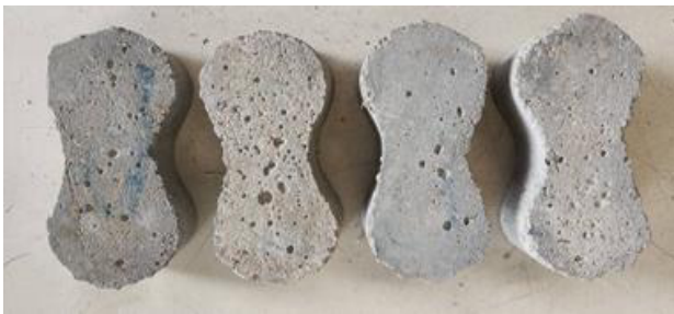
รูปที่ 9 ก่อนตัวอย่างการทดสอบค่ากำลังรับแรงดึง
