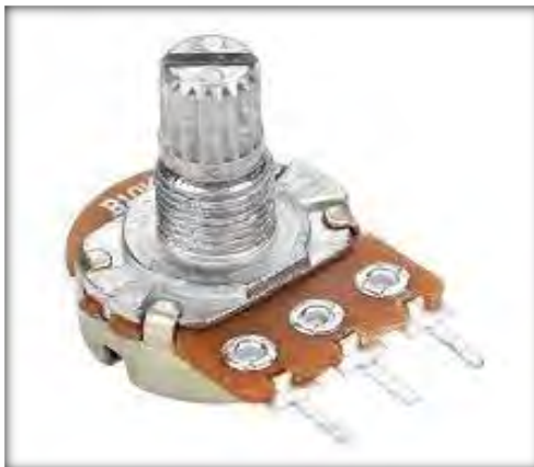
รูปที่ 2.2 ตัวต้านทานที่เปลี่ยนค่าได้ (Variable Value Resistor)
