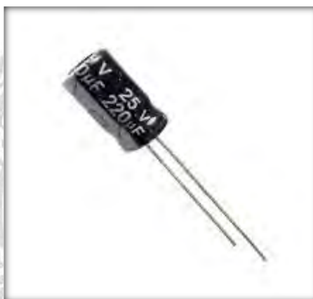
รูปที่ 2.6 ตัวเก็บประจุชนิดน้ำยา (Electrolyte Capacitor)
