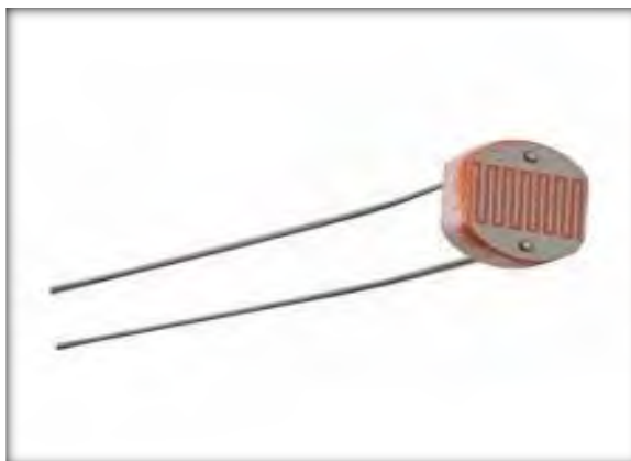
รูปที่ 2.3 ตัวต้านทานไวแสง หรือ LDR (Light Dependent Resistor)
