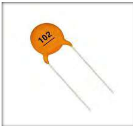
รูปที่ 2.5 ตัวเก็บประจุชนิดเซรามิก (Ceramic Capacitor)
