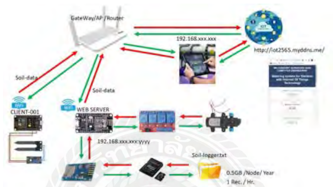
รูปที่ 3.3การทำงานและการสื่อสารของทั้งระบบ
