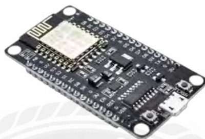
รูปที่ 2.2 Node MCU ESP8266
