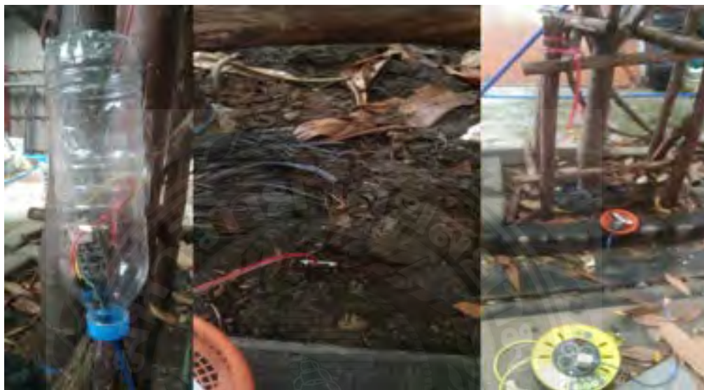
รูปที่ 4.3 NODE MCU ESP8266 และ Soil Moisture Sensor Module
