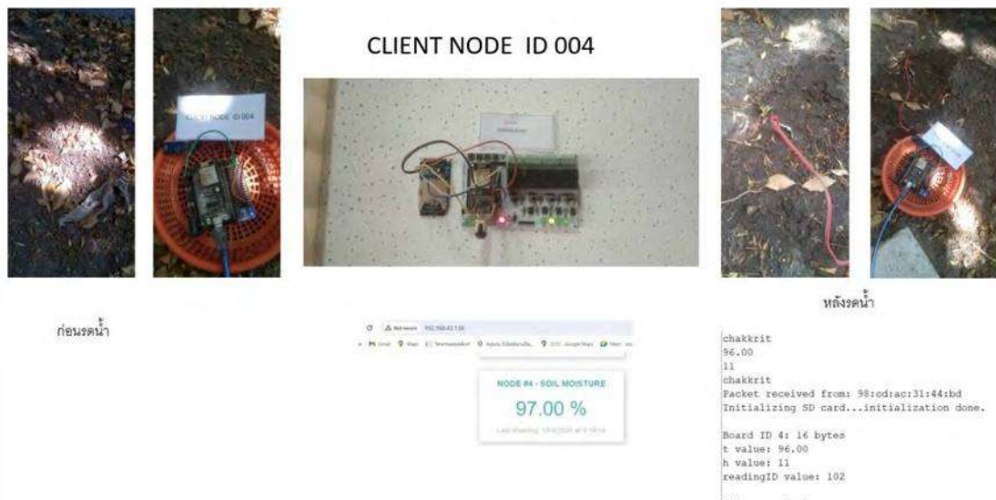
รูปที่ 4.10 ความชื้นในดินที่ส่งมาจาก client node ด้วยการดูผ่าน web browser
