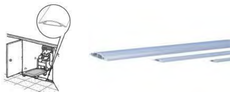
รูปที่ 2.29 รางชนิดติดตั้งบนพื้น ( Floor Duct )
