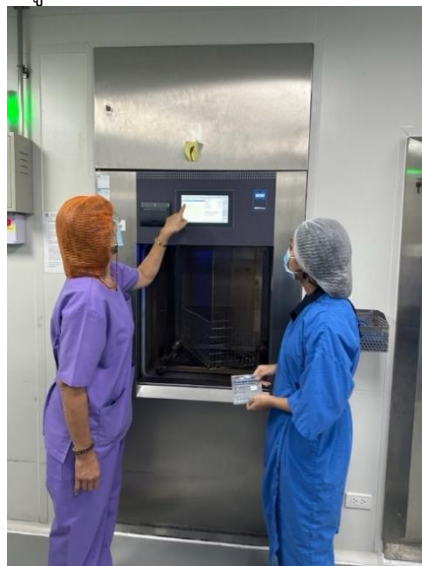
ภาพที่ 1 แสดงการเตรียมเครื่องเพื่อทำการทดสอบ Bowie-Dick Test Pack ในเครื่องทำให้ปราศจากเชื้อด้วยแรงดันไอน้ำ
