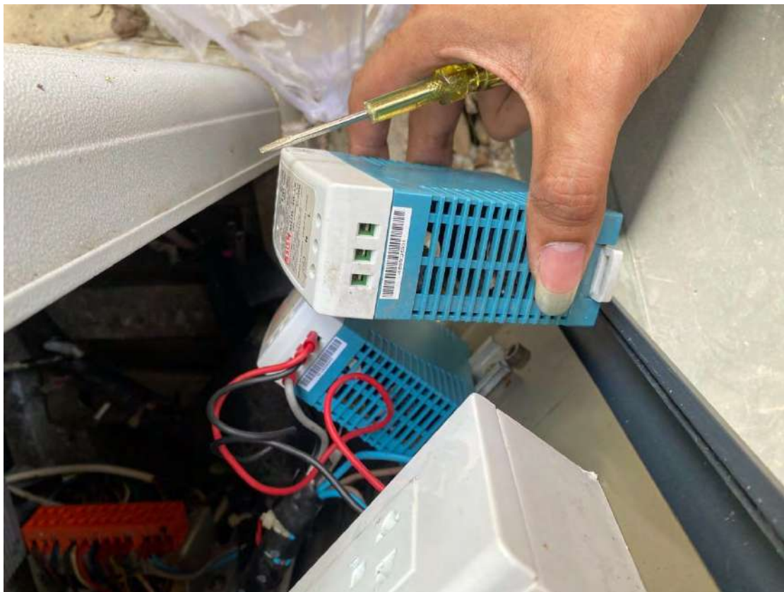
รูปที่ 4.7 ทำการเปลี่ยน Switching ให้กับลูกค้า
