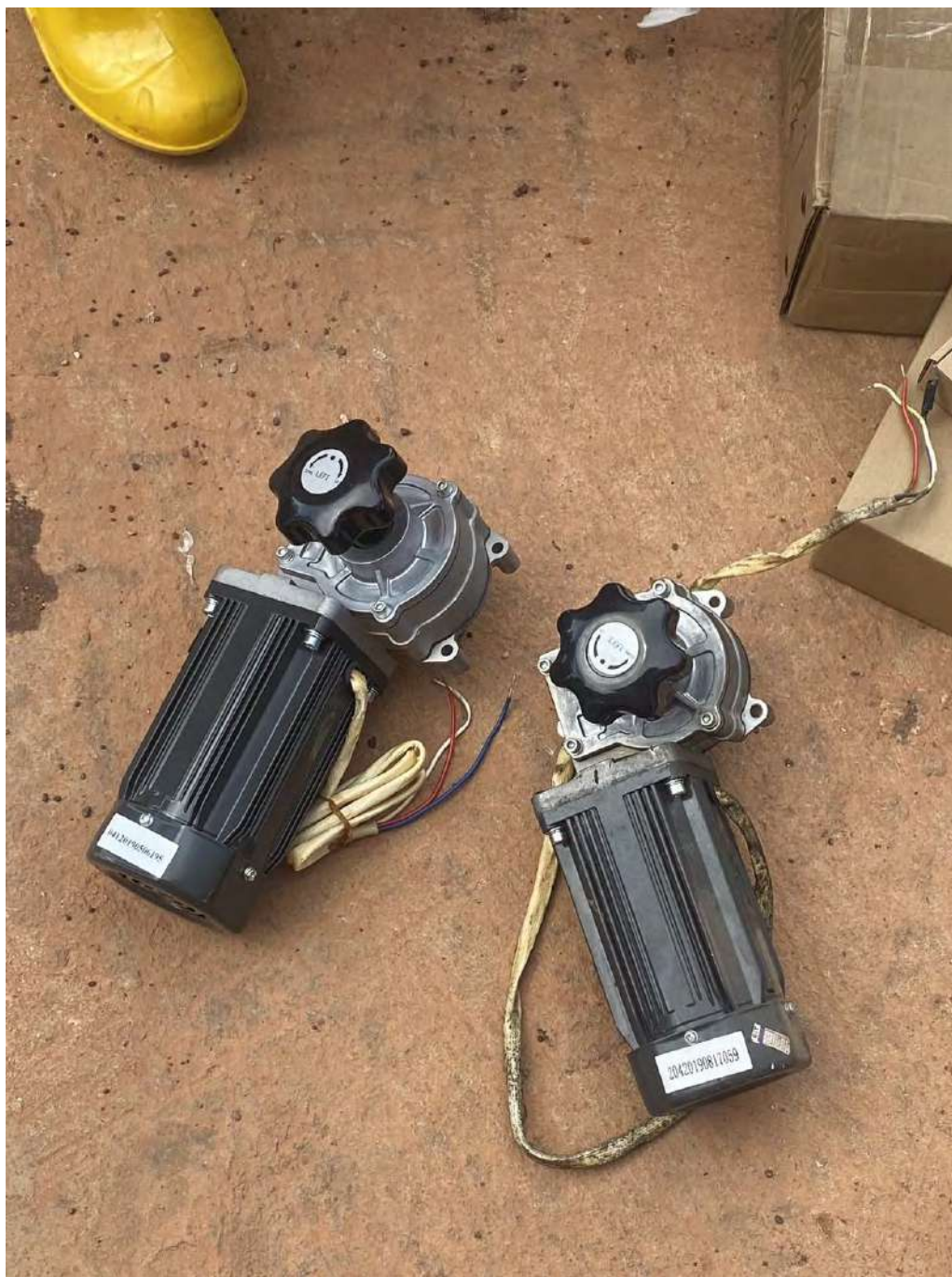
รูปที่ 4.9 ทำการเปลี่ยนมอเตอร์ DC ของไม้กันที่เสีย
