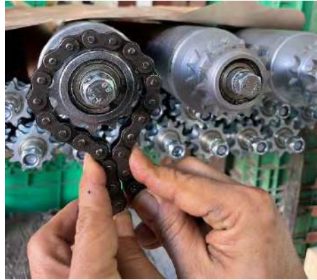
รูปภาพการตรวจสอบเฟืองที่ขนาดผิดพลาด
