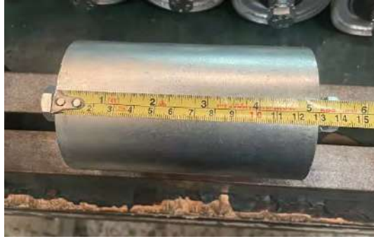
รูปภาพที่ 3.2 รูปตัวอย่างลูกกลิ้งรองสายพานด้านหน้า (ลิขสิทธิ์ภาพของบริษัทบริษัท สปีดเวย์โรลเลอร์ & คอนเวเยอร์ จำกัด)
