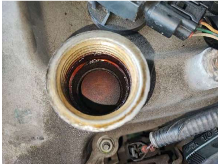
รูปที่ 4.3 คราบวานิชในฝาสูบ
