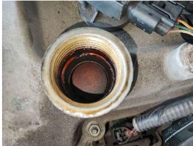
รูปที่ 3.8 คราบวานิชในฝาสูบ
