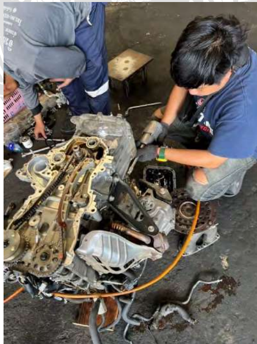
ภาพที่ 5 การเปลี่ยนแครงอ่างน้ำมันเครื่อง
