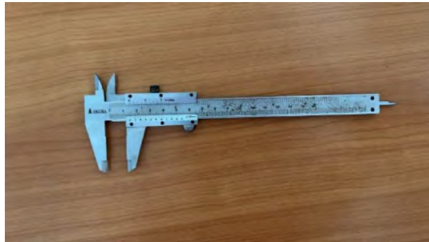
รูปที่ 3.2 เวอร์เนียคาลิปเปอร์
