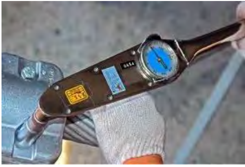
รูปที่ 2.2 ประแจปอนด์สำหรับ สำหรับหรับวัดค่าแรงบิดแบบหน้าปัด แบบเข็ม
