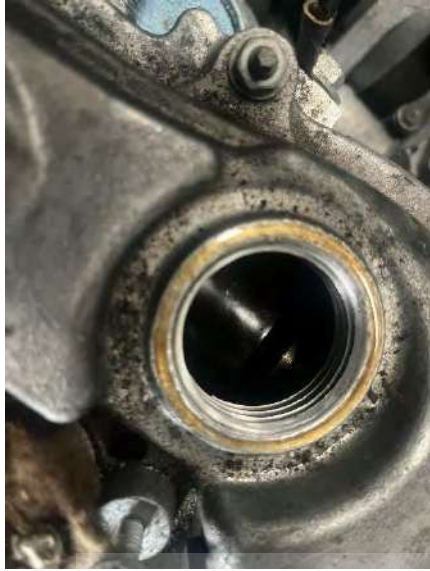
รูปที่ 2.16 เช็คราบเขม่าเครื่องยนต์เก่า
