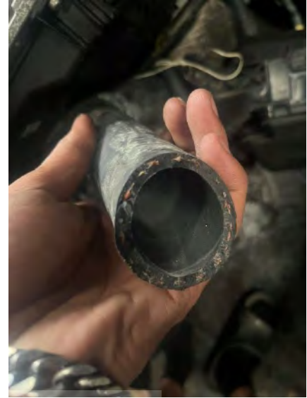
รูปที่ 2.17 เช็คราบสนิมระบบทางเดินน้ำหล่อเย็น
