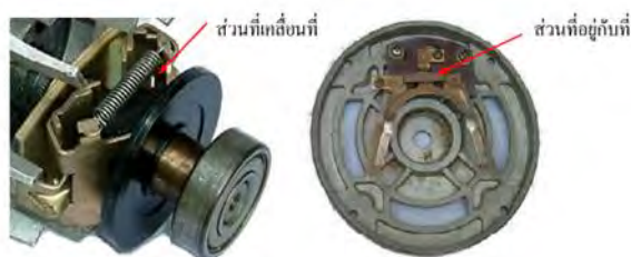
รูปที่ 2.28 สวิตช์แรงเหวี่ยง (Centrifugal Switch)
