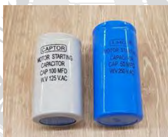
รูปที่ 2.20 สตาร์ทคาปาซิเตอร์ (Start Capacitors)
