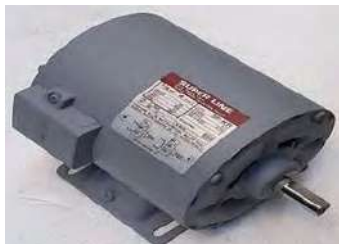
รูปที่ 2.24 สปลิตเฟสมอเตอร์ (Split-Phase Motor)
