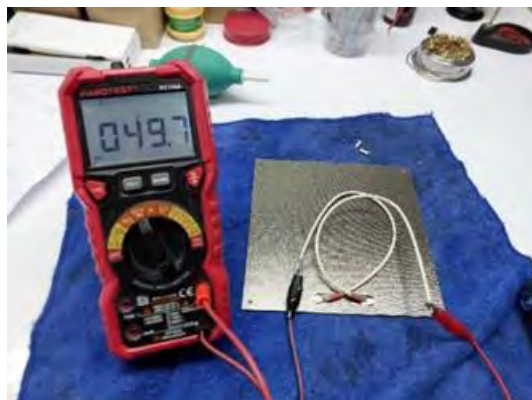
รูปที่ 4.14 ใช้มัลติมิเตอร์วัดค่าความต้านทานฮีตเตอร์
