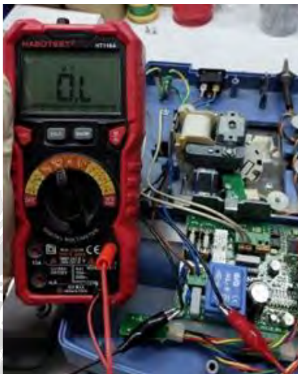
รูปที่ 4.18 ใช้มัลติมิเตอร์วัดค่าขดลวดมอเตอร์
