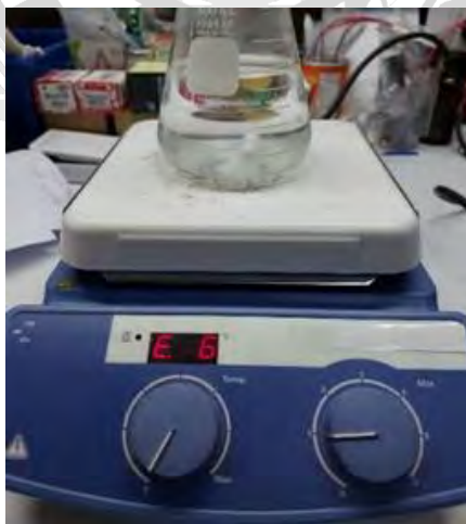
รูปที่ 4.17 เครื่องผิดปกติหน้าจอแสดงผลขึ้น Code E6
