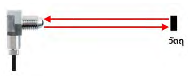
รูปที่ 2.39 เซนเซอร์ประเภทตรวจจับโดยตรง
