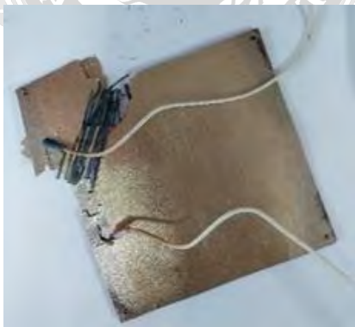
รูปที่ 4.11 สภาพฮีตเตอร์ที่ชำรุดกรอบแตก
