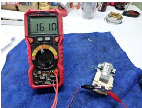
รูปที่ 4.22 ค่าความต้านทานขดลวดมอเตอร์ที่ปกติ
