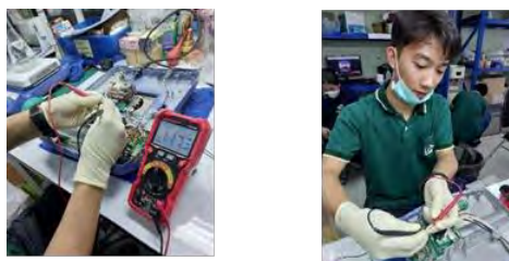
รูปที่ 4.2 การตรวจวัดค่าความต้านทานของ RTD
