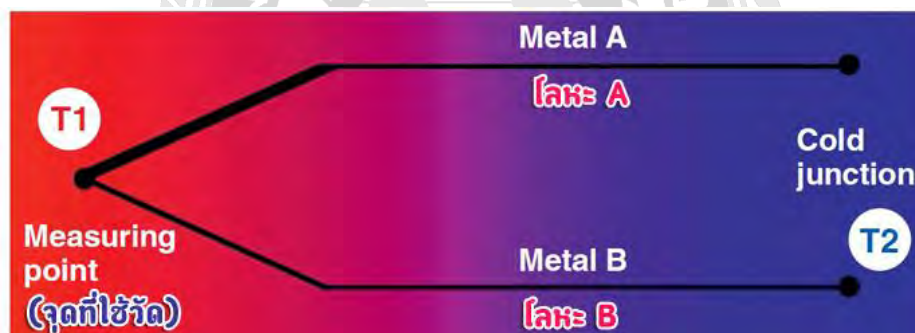
รูปที่ 2.8 การต่อลวดโลหะ A และลวดโลหะ B ของเทอร์โมคัปเปิล
