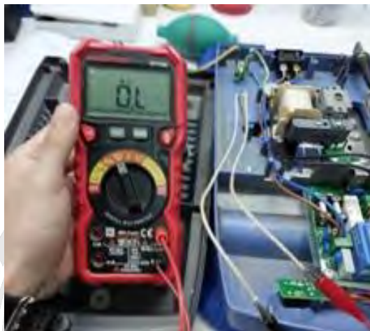
รูปที่ 4.10 การใช้มัลติมิเตอร์วัดค่าความต้านทานฮีตเตอร์
