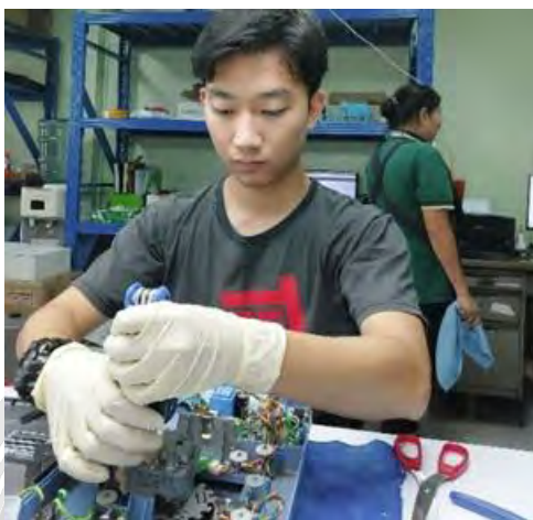
รูปที่ 4.20 ทำการถอดมอเตอร์ตัวที่ชำรุด
