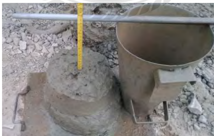
ภาพที่ 4-12 การตรวจสอบค่ายุบตัวอยู่ที่ 17.5 \pm 2.5 เซนติเมตร
