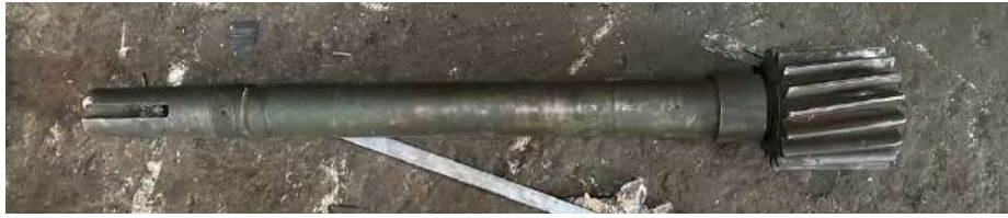
รูปที่ 3.23 เฟืองขับที่ต่อกับเพลาชับที่ถอดมาจากเครื่องบีบเพื่อเป็นตัวอย่างในการเขียนแบบ
