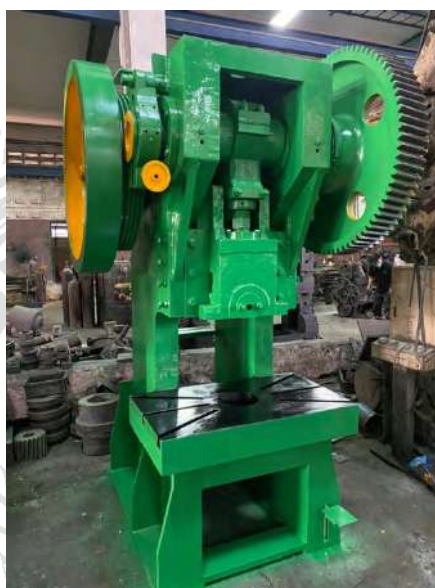
รูปที่ 3.6 เครื่องปั๊มขนาด 120 ตัน ต้นแบบที่ใช้ในการร่างแบบ
