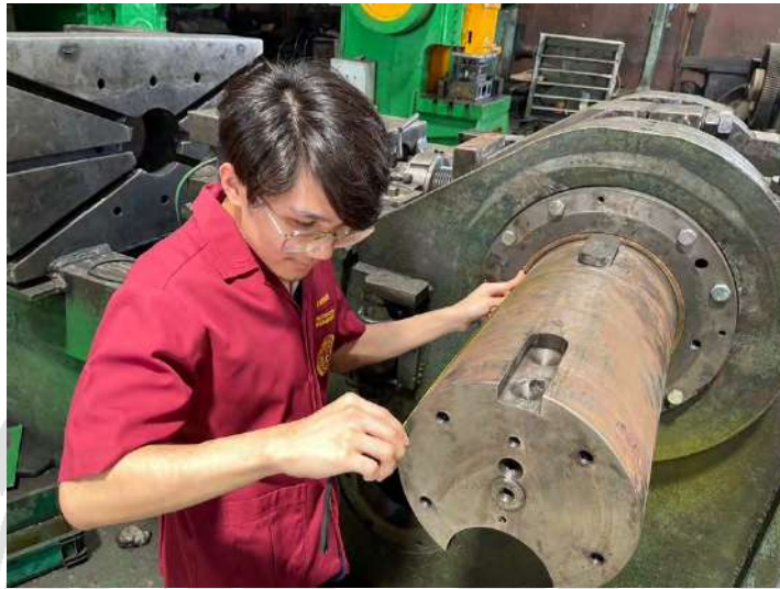
รูปที่ ง.1 วัดเพลาคือแหียงจากเครื่อง 120 ตัน ที่ทำการซ่อมอยู่
