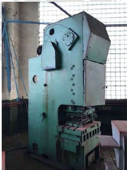
รูปที่ 2.5 เครื่องปั๊มโลหะข้อเหวี่ยงที่มีการทำงานแบบขั้นตอนเดียว
