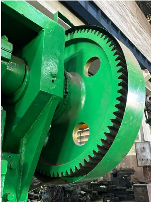
รูปที่ 3.21 เฟืองตามกับฝาครอบเฟืองเพื่อป้องกันศีรษะ
