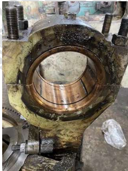
รูปที่ 3.20 ภายในของก้านชักจะมีจุดอัดจาระบีและวัตถุเป็นทองเหลือง
