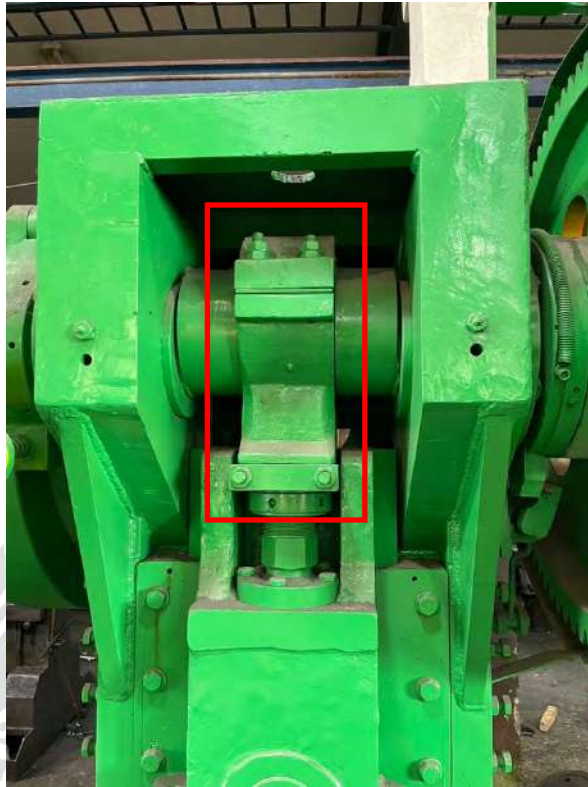
รูปที่ 3.19 ก้านชักในส่วนยึดติดกับเพลาค้อนเหวี่ยงและลูกหมวก
