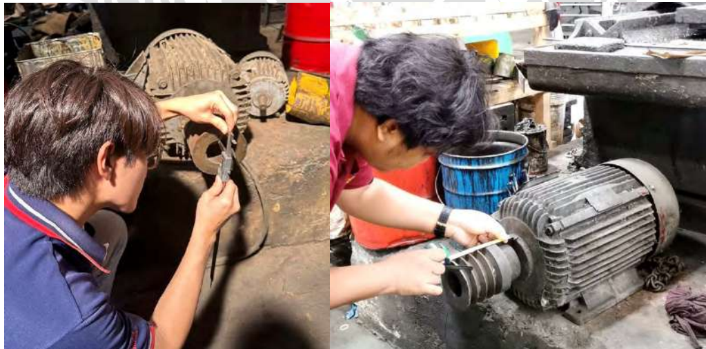
รูปที่ ง.2 วัดขนาดมูเลย์และรองสายพาน วิเคราะห์กำลังของมอเตอร์ เพื่อนำไปเขียนแบบ
