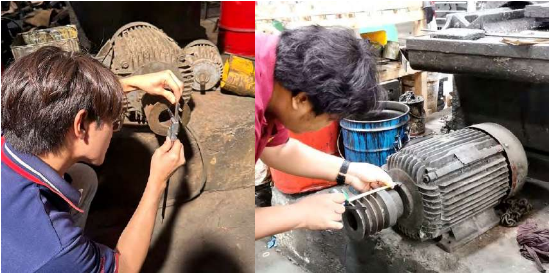
รูปที่ 3.26 วัดขนาดมุขและรองสายพาน วิเคราะห์กำลังของมอเตอร์ เพื่อนำไปเขียนแบบ
