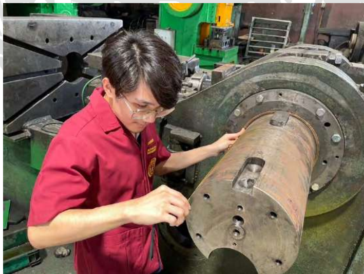
รูปที่ 3.14 วัดเพลาค้อเหวี่ยงจากเครื่อง 120 ตัน ที่ทำการซ่อมอยู่
