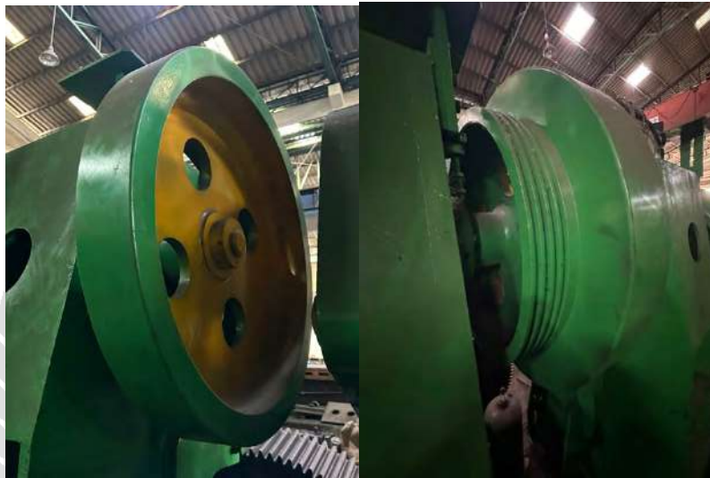
รูปที่ 3.24 มูเลย์สายพานเพื่อส่งกำลังไปยังเพลาชับ
