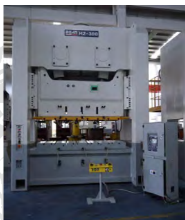
รูปที่ 2.6 เครื่องปั๊มโลหะข้อเหวี่ยงที่มีการทำงานสองขั้นตอน
