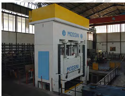
รูปที่ 2.7 เครื่องปั๊มโลหะข้อเหวี่ยงที่มีการทำงานสามขั้นตอน
