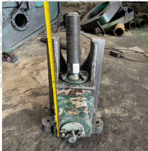
รูปที่ 3.16 วัดขนาดเพื่อเปรียบเทียบในการเขียนแบบชิ้นงานในส่วนของหัวปั๊ม
