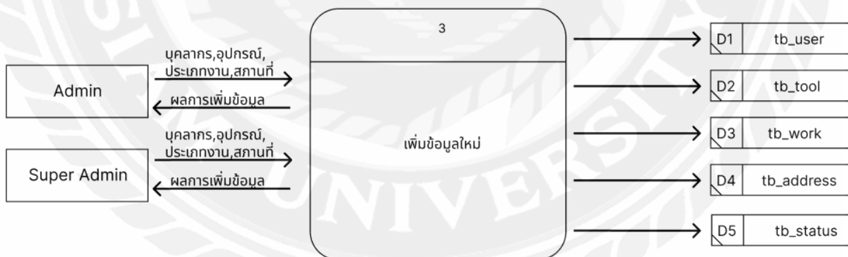
รูปที่ 3.6 Data Flow Diagram Level 1 ในส่วนของ เพิ่มข้อมูลใหม่
