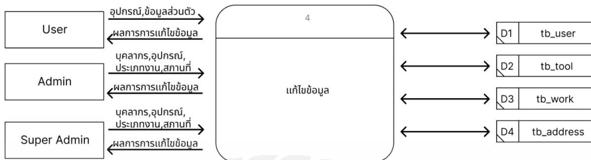
รูปที่ 3.7 Data Flow Diagram Level 1 ในส่วนของ แก้ไขข้อมูล
