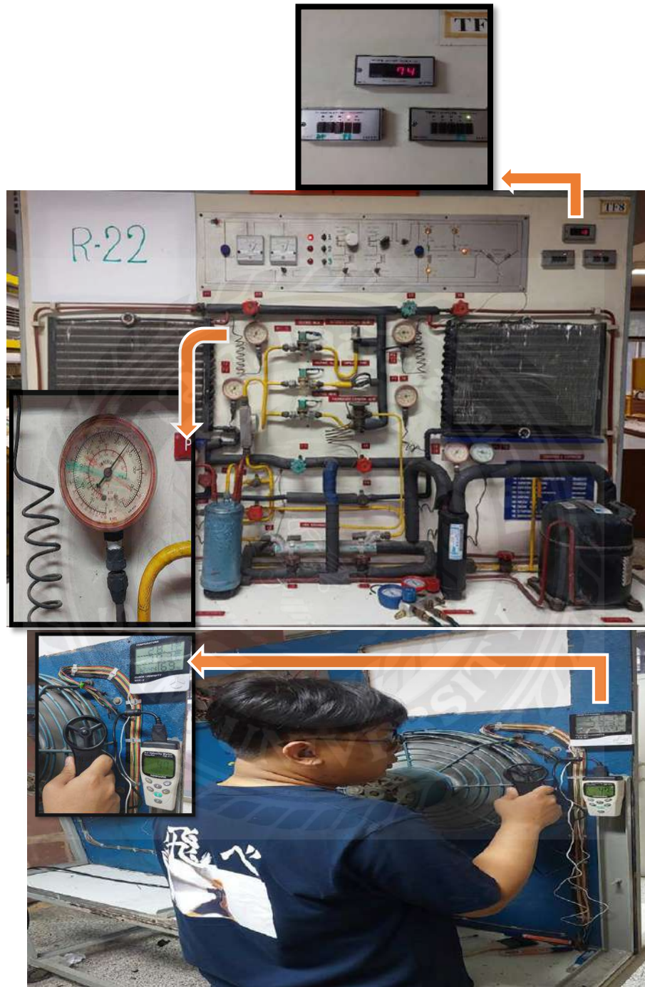
รูปที่ 4.5 แสดงอุณหภูมิและความดัน Condenser ของ Capillary Tube
