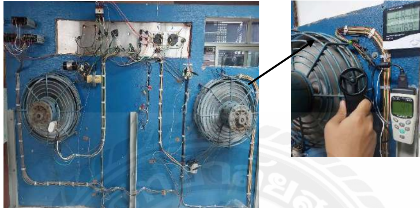
รูปที่ 3.9 วัดอุณหภูมิและความชื้น ฝั่งลมจ่ายของ Condenser
