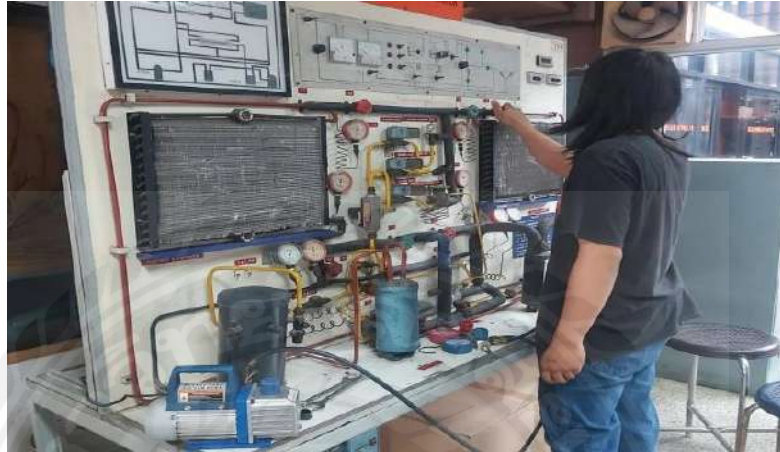
รูปที่ 3.3 แสดงขั้นตอนการตรวจสอบระบบปรับอากาศ
