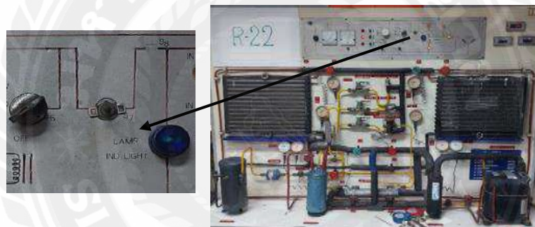
รูปที่ 3.7 สวิตซ์การทำงานของ Compressor
