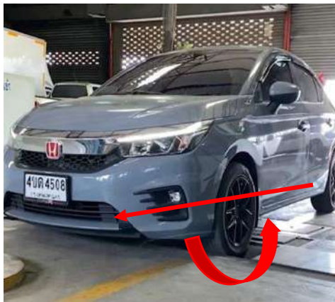
รูปที่ 4.19 ตรวจสอบระบบห้ามล้อเพลาลูกหน้า รูปที่ 4.20 หน้าจอแสดงผลห้ามล้อเพลาลูกหน้า
