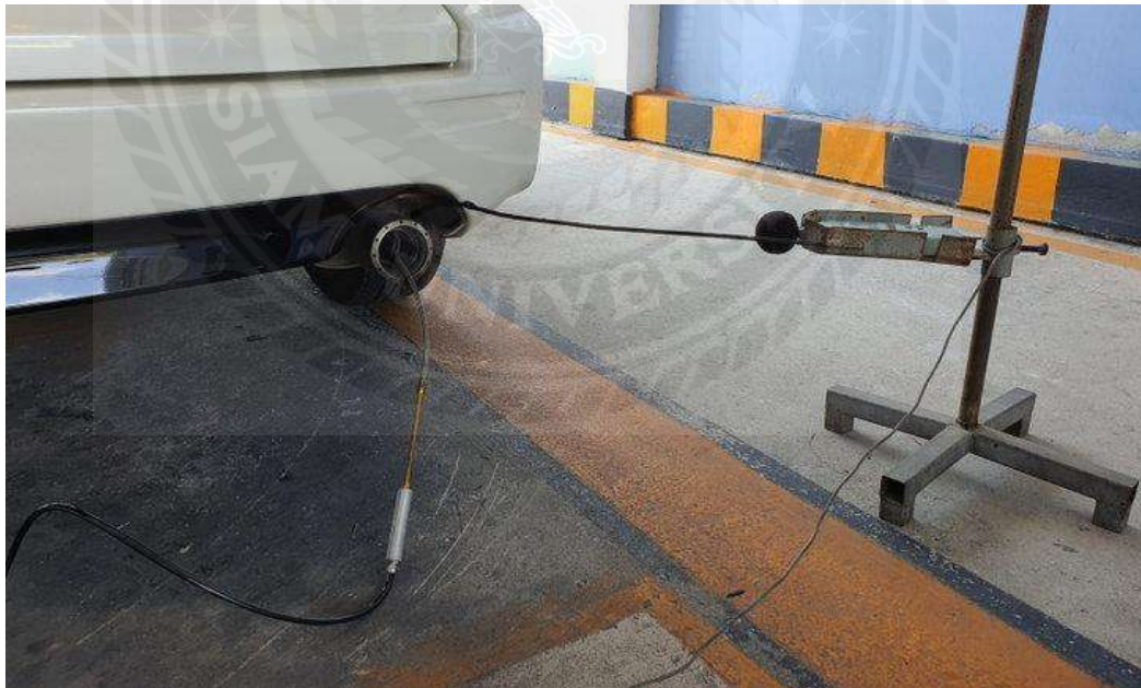
รูปที่ 2.2 ตรวจวัดคาร์บอนมอนอกไซด์ (CO) และไฮโดรคาร์บอน (HC)
