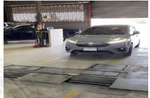
รูปที่ 2.34 ตรวจสอบ Side Slip เพลาน้ำ
