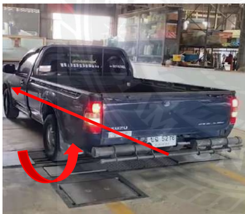
รูปที่ 4.11 ตรวจสอบระบบห้ามล้อเพลาหลัง
