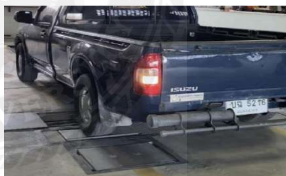
รูปที่ 3.8 ตรวจสอบระบบรองรับ
