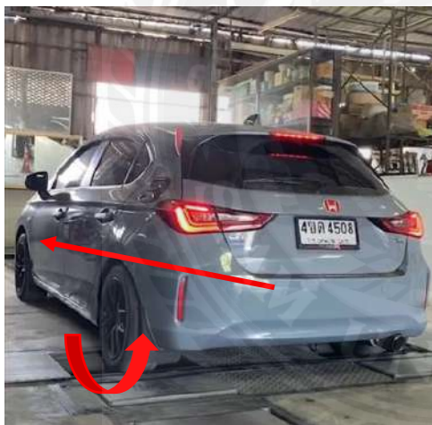
รูปที่ 4.24 ตรวจสอบระบบห้ามล้อเพลาหลัง
