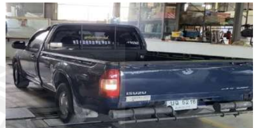
รูปที่ 2.38 ตรวจสอบระบบรองรับน้ำหนักเพลาลัง
