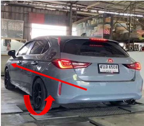
รูปที่ 4.26 ตรวจสอบระบบ ห้ามล้อเพลาลัง(ห้ามล้อมือ)
