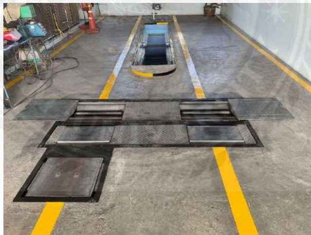
รูปที่ ก.2 เครื่องทดสอบระบบรองรับน้ำหนักและประสิทธิภาพห้ามล้อ
