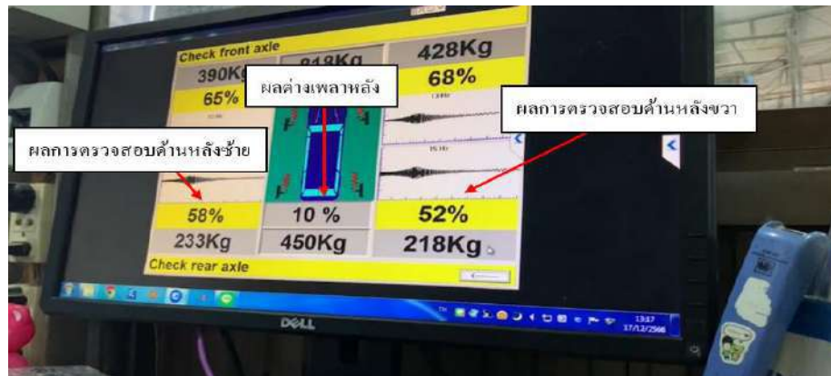
รูปที่ 4.23 ตรวจสอบระบบการยึดเกาะถนนเพลาหลัง
