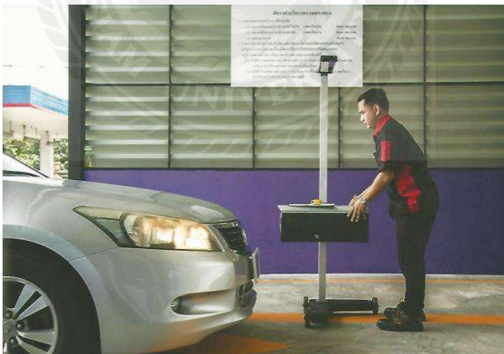
รูปที่ 3.22 วัดระยะห่างโคมไฟหน้ากับเครื่องทดสอบ
