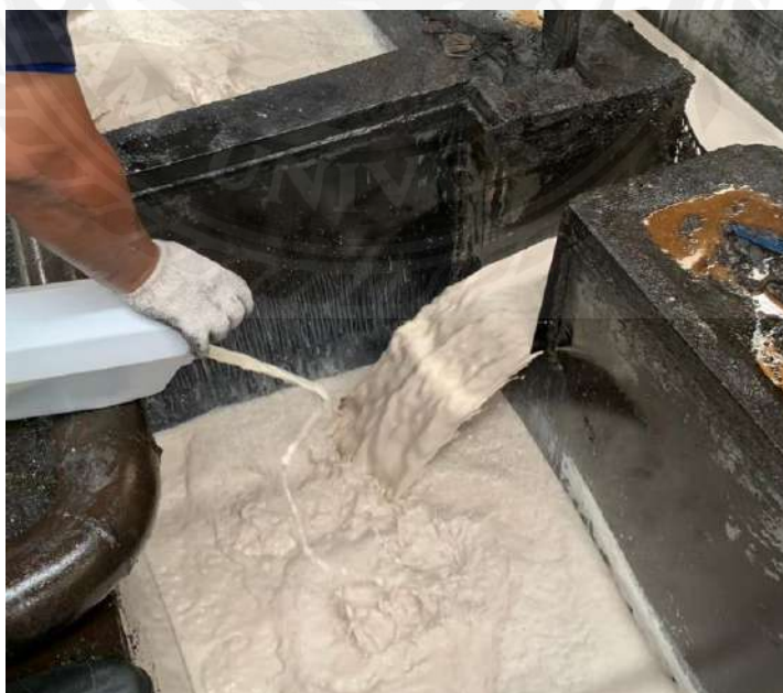
รูปที่ 3.11 การเติมน้ำยาหล่อเย็นเข้าไปเพิ่ม
