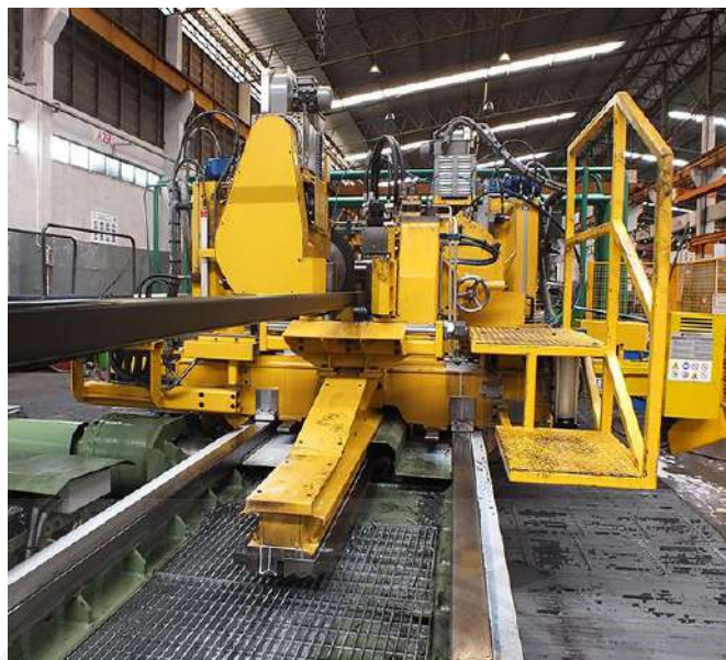
รูปภาคผนวกที่ 3 ขั้นตอนการตัดท่อเหล็ก
