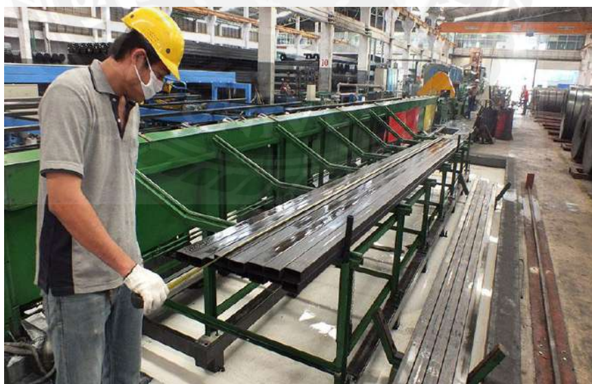
รูปที่ 2.13 การตรวจสอบขนาดเส้นผ่านศูนย์กลางภายนอก ความหนาและความยาวของท่อเหล็ก
