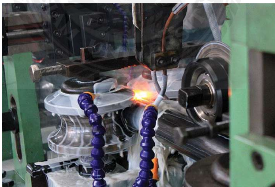
รูปที่ 2.11 การเชื่อมตะเข็บท่อเหล็ก
