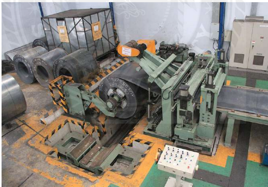
รูปที่ 2.7 การแปรรูปเหล็กม้วนให้มีขนาดหน้ากว้างเล็กลง
