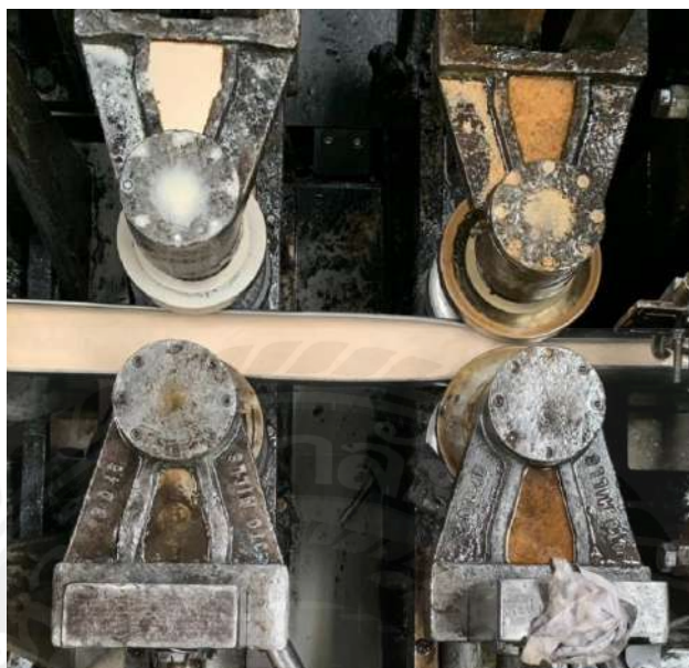
รูปภาคผนวกที่ 1 ขั้นตอนการขึ้นรูปท่อเหล็ก
