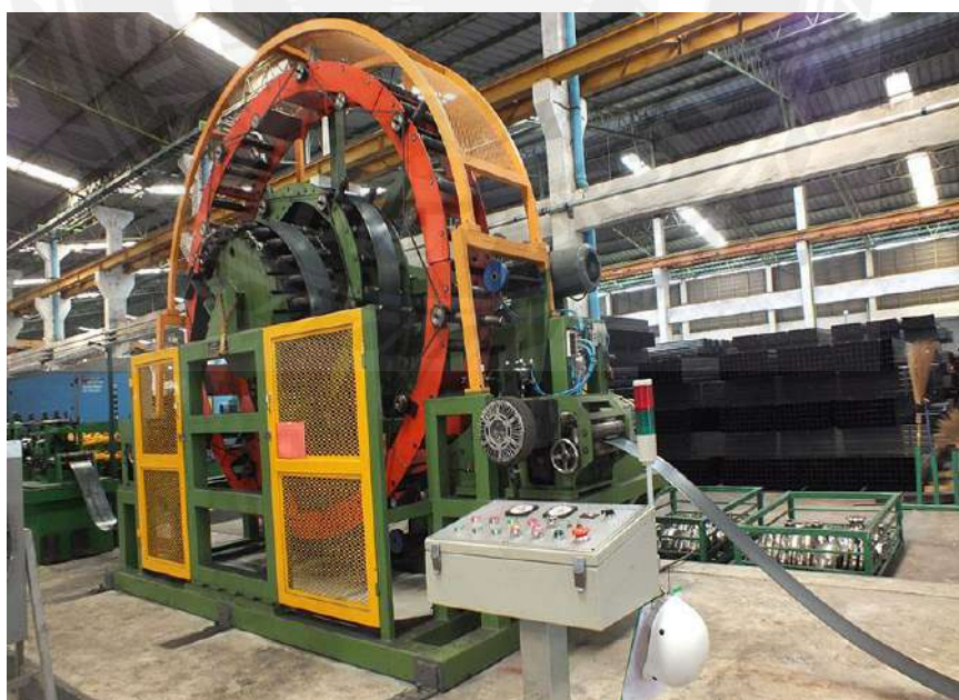
รูปที่ 2.9 การรีดและการเก็บแผ่นเหล็กก่อนการขึ้นรูปท่อเหล็ก
