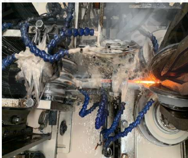
รูปภาคผนวกที่ 2 ขั้นตอนการเชื่อมตะเข็บท่อเหล็ก
