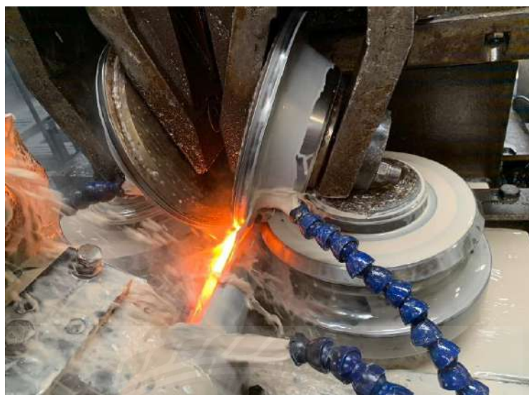
รูปที่ 2.2 การเชื่อมตะเข็บท่อเหล็กแบบ ERW
