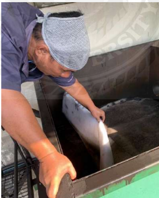
รูปที่ 3.9 การเปลี่ยนแผ่นฟิลเตอร์กรองน้ำหล่อเย็น
