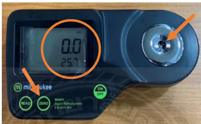
รูปที่ 3.6 การ Set zero เครื่องวัดความหวาน (Refractometer)
