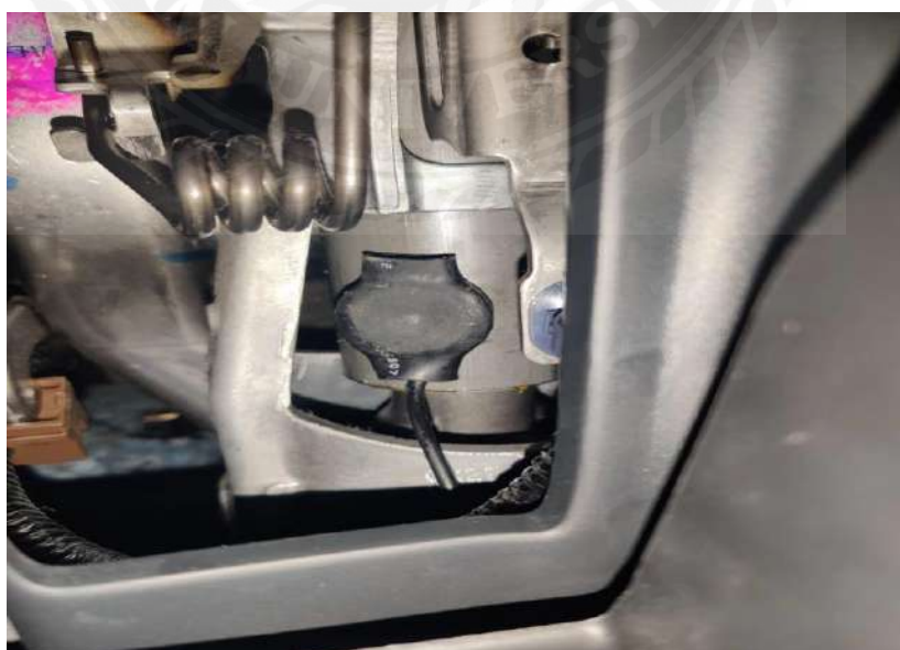
รูปที่ 3.4 การติดตั้งเครื่องวิเคราะห์เสียงผิดปกติส่วนแกนพวงมาลัย
