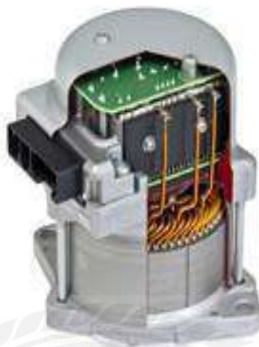
รูปที่ 2.53 ระบบพวงมาลัยเพาเวอร์ไฟฟ้าแบบรวมระบบควบคุมและมอเตอร์
