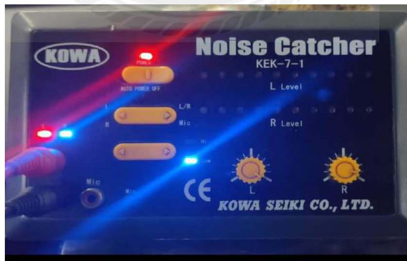
รูปที่ 4.5 การทดสอบเครื่องมือวิเคราะห์เสียงคันที่ 2 ไม่พบเสียงผิดปกติ
