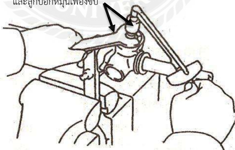
รูปที่ 2.45 ประกอบน็อตล็อกปลอกเกลียวปรับลูกปืนเฟืองขับ
