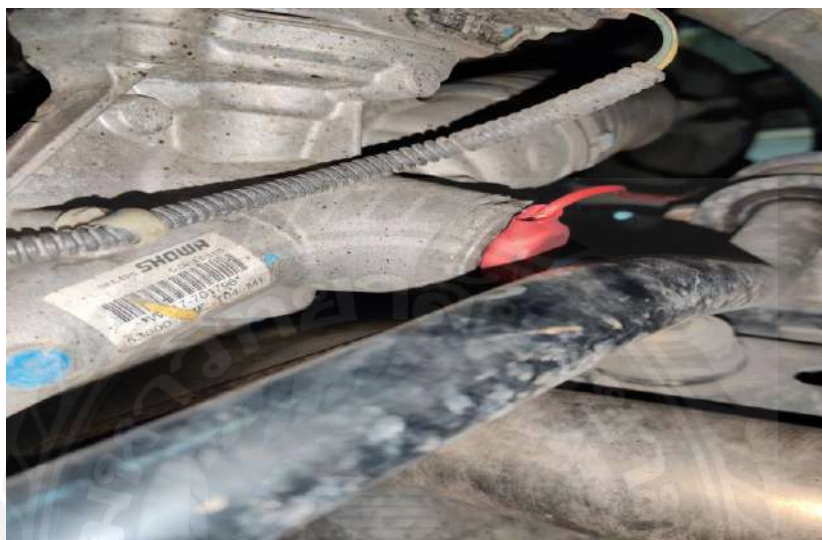
รูปที่ 3.3 การติดตั้งเครื่องวิเคราะห์เสียงผิดปกติส่วนแร็คพวงมาลัย
