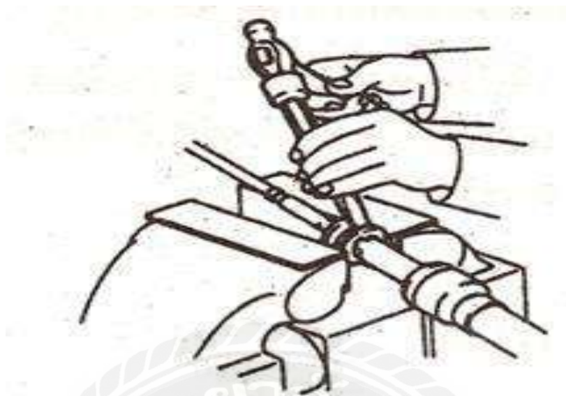
รูปที่ 2.30 ถอดคั่นส่งออกจากปลายเฟืองสะพานและแหวนล็อก ใช้ประแจถอดคั่นส่ง ถอดคั่นส่งที่ปลายเฟืองสะพานออกทำเครื่องหมายซ้ายและขวาที่ปลายเฟือง สะพานถอดแหวนล็อกออก
