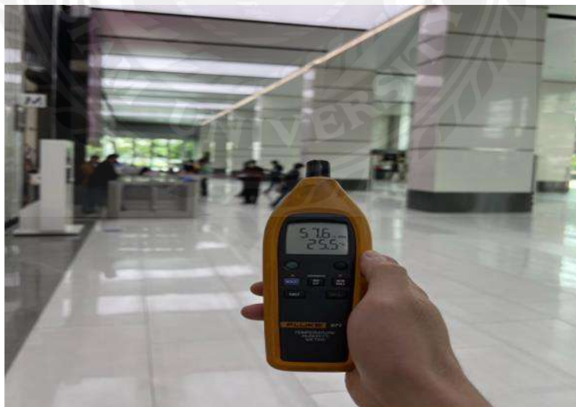
รูปภาพผนวก ที่ 12 วัดอุณหภูมิในโซนสำนักงาน
