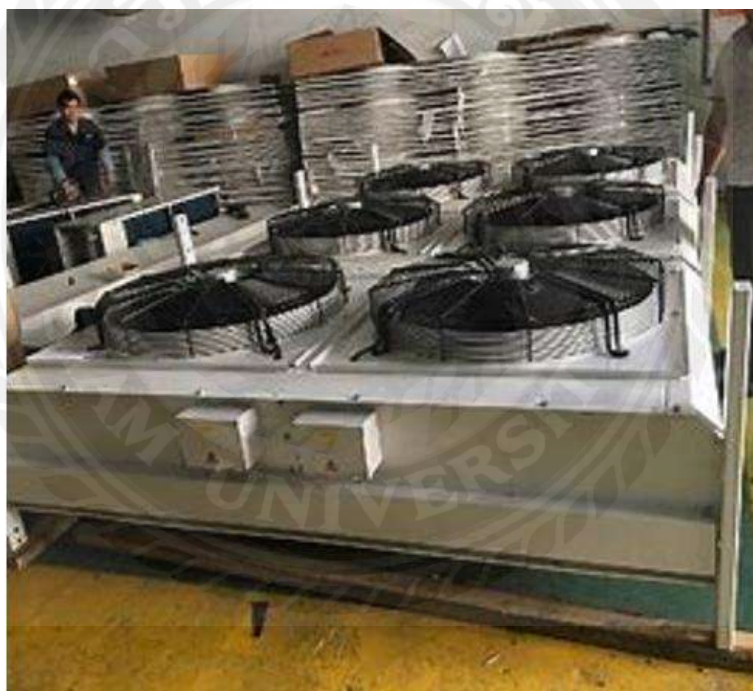
รูปที่ 2.5 คอนเดนเซอร์ระบายความร้อนด้วยอากาศ
