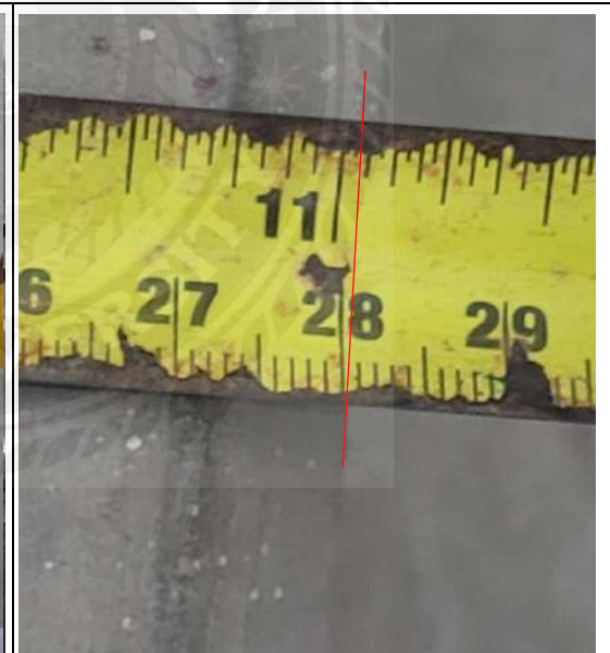
รูปภาคผนวก ที่ 20 วัดลูกนอนบันไดที่ 2 ได้ 28 cm
