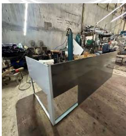
รูปที่ 4.8 การยึดตรึงโครงตู้ด้านในกับด้านนอก และการฉีตซิลิโคนยาแนวตะเข็บรอยต่อ
