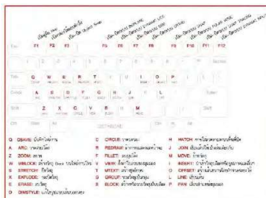
รูปที่ 2.22 คีย์ลัดที่ใช้ในโปรแกรมเขียนแบบ AutoCAD
