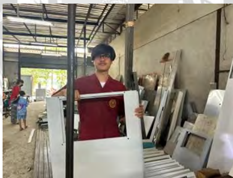
รูปที่ 4.5 ชิ้นงานที่ได้จากการปั๊มเจาะรู และปั๊มขึ้นขอบชิ้นงานเรียบร้อยแล้ว
