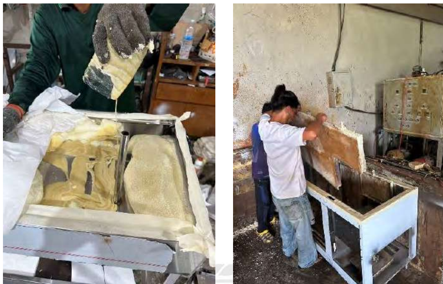
รูปที่ 4.9 การติดตั้งฉนวนความร้อน (Polyurethane Foam) ภายในตู้แช่
