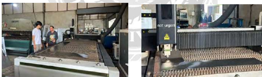
รูปที่ 4.3 การบากชิ้นงานด้วยเครื่องตัดโลหะแผ่น
