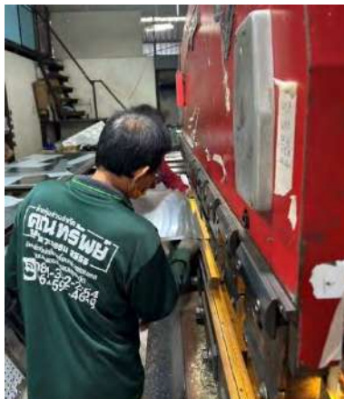
รูปที่ 4.4 การพับขึ้นรูปชิ้นงานโดยเครื่องจักร
