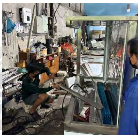
รูปที่ 4.7 การประกอบโครงตู้ด้านในเข้ากับโครงตู้ด้านนอก
