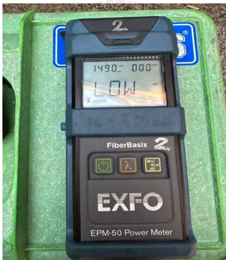
รูปที่ 3.3 เครื่อง Optical Power Meter (Optical Power Meter)
