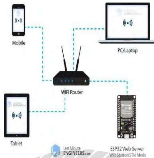
รูปที่ 6 การเชื่อมต่อของ Router และอุปกรณ์ต่างๆแบบไร้สาย
