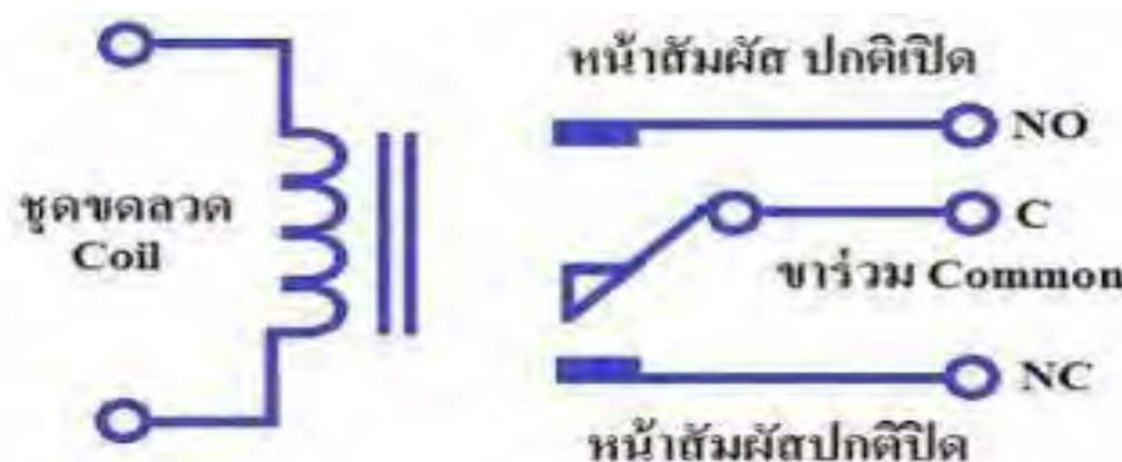
รูปที่ 2.9 หน้าสัมผัสของ Relay ในสภาพปกติจะปิด
