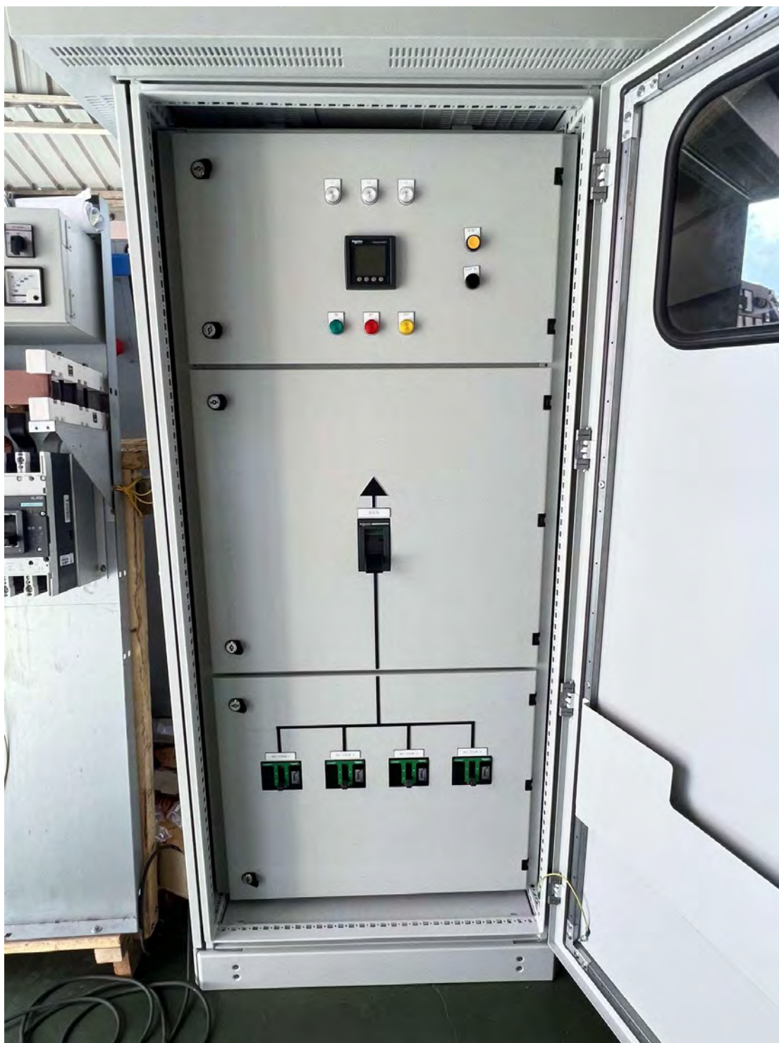
รูปที่ 4.25 สวิตช์บอร์ดสำเร็จรอตดสอบ
