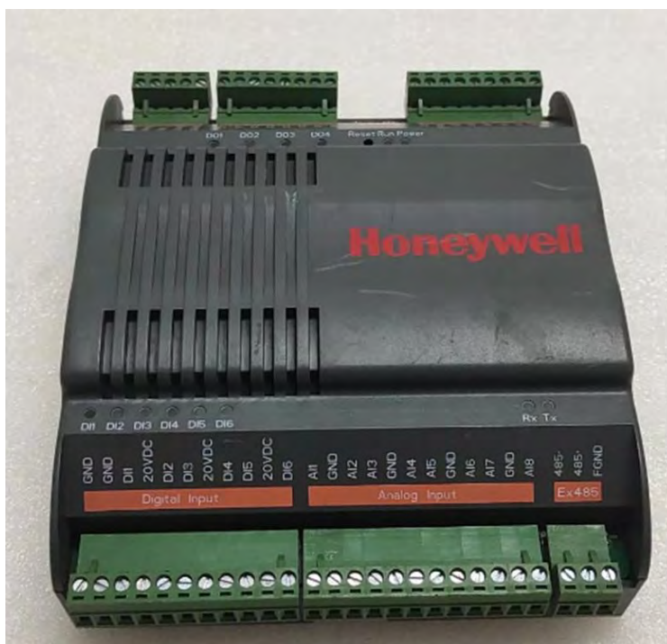
รูปที่ 2.21 PLC
