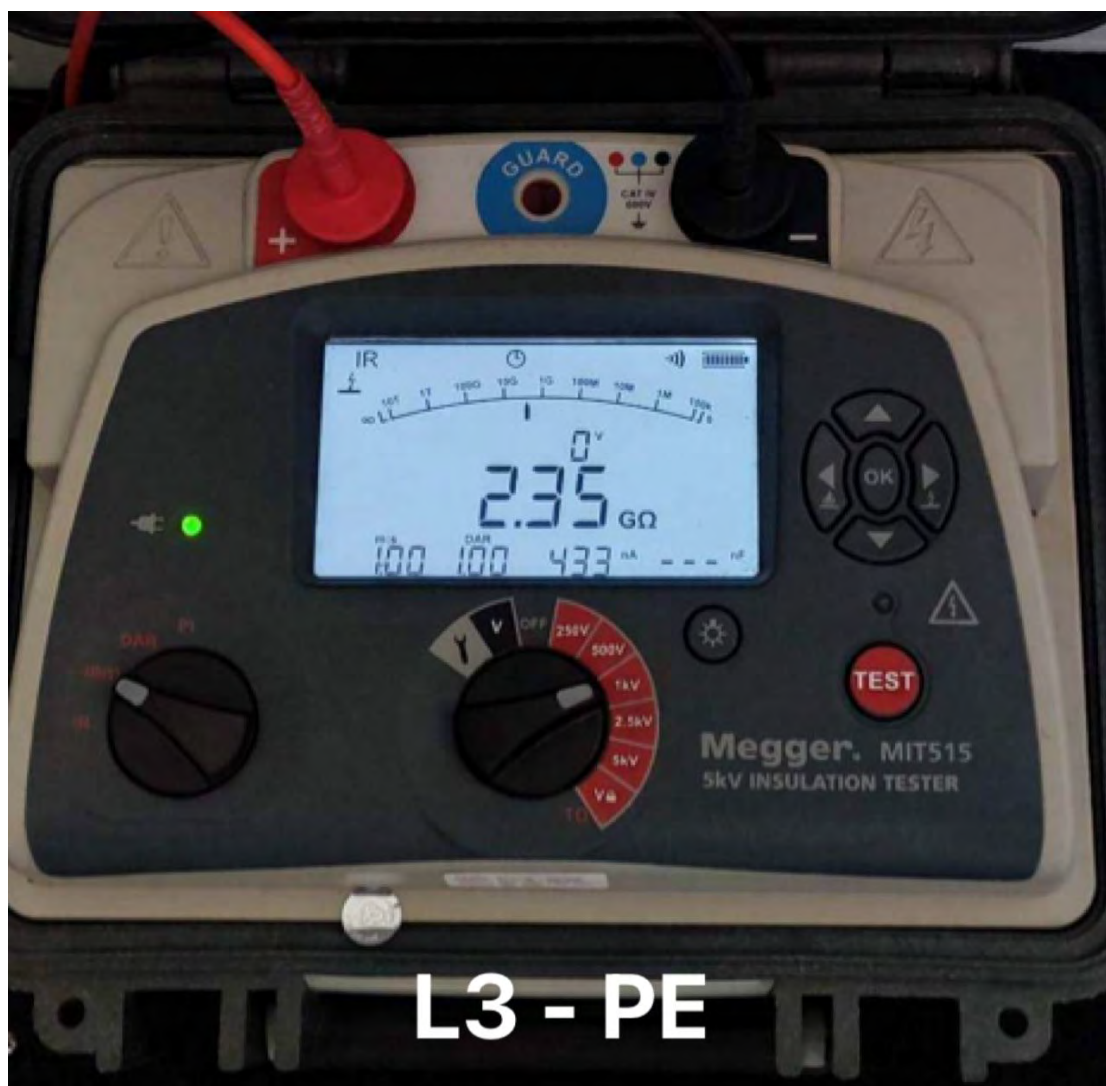
รูปที่ 4.32 ทดสอบค่าความเป็นฉนวนของ L3-PE
