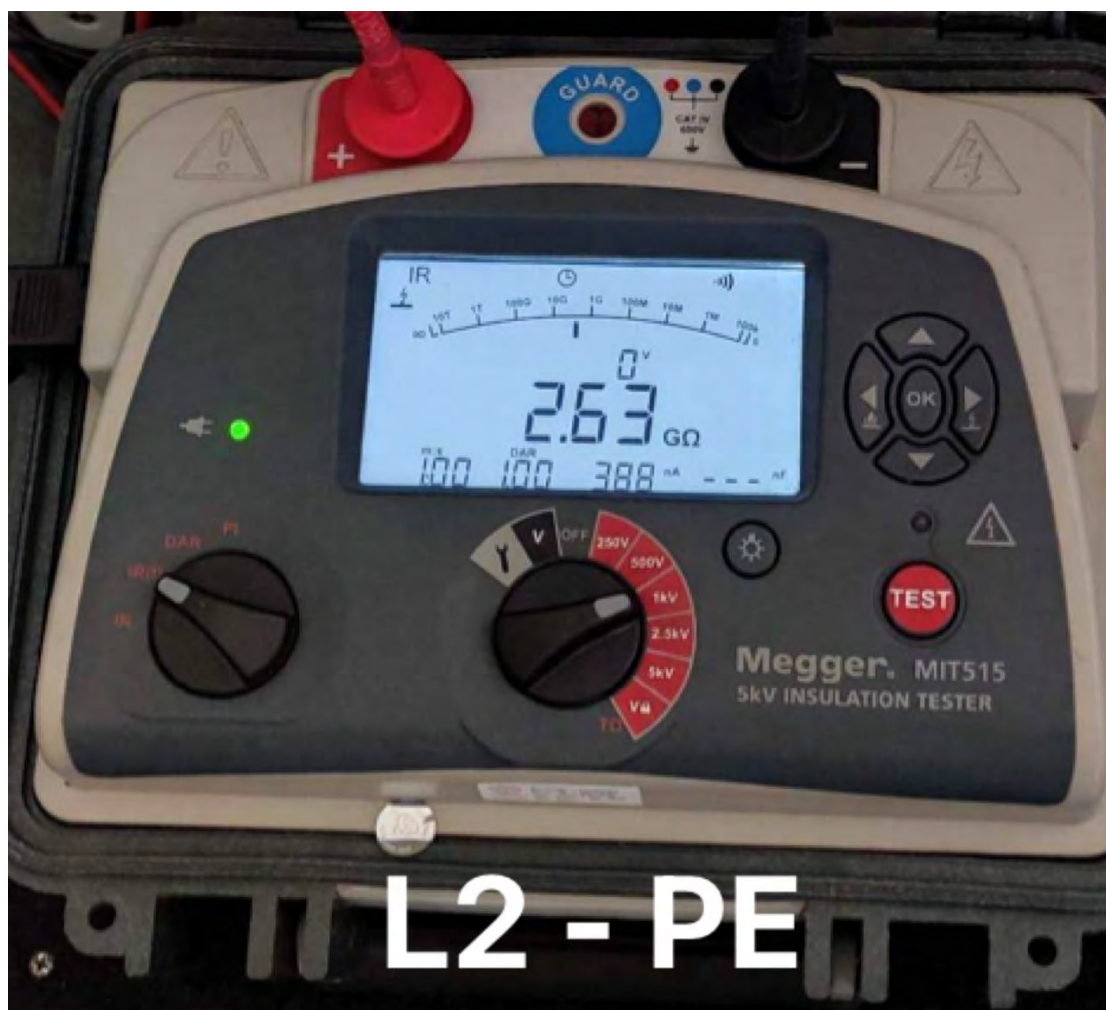
รูปที่ 4.31 ทดสอบค่าความเป็นฉนวนของ L2-PE
