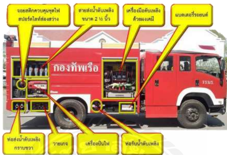
รูปที่ 2.3 ระบบเครื่องยนต์สูบน้ำดับเพลิง
