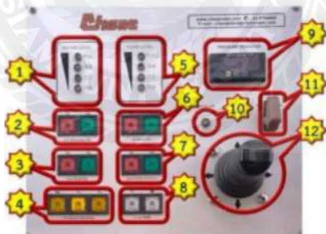
รูปที่ 2.8 แผงควบคุมป็นฉีดยาน้ำบนหลังคารถ
