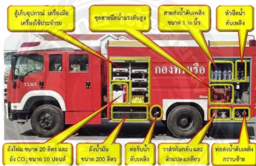
รูปที่ 2.4 ระบบปั้มน้ำดับเพลิง
