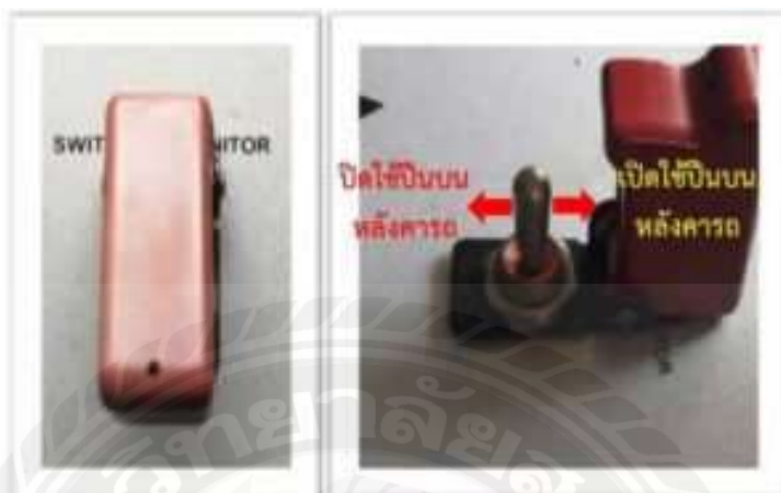
รูปที่ 2.7 แผงควบคุมป็นฉีดยาน้ำบนหลังคารถ
