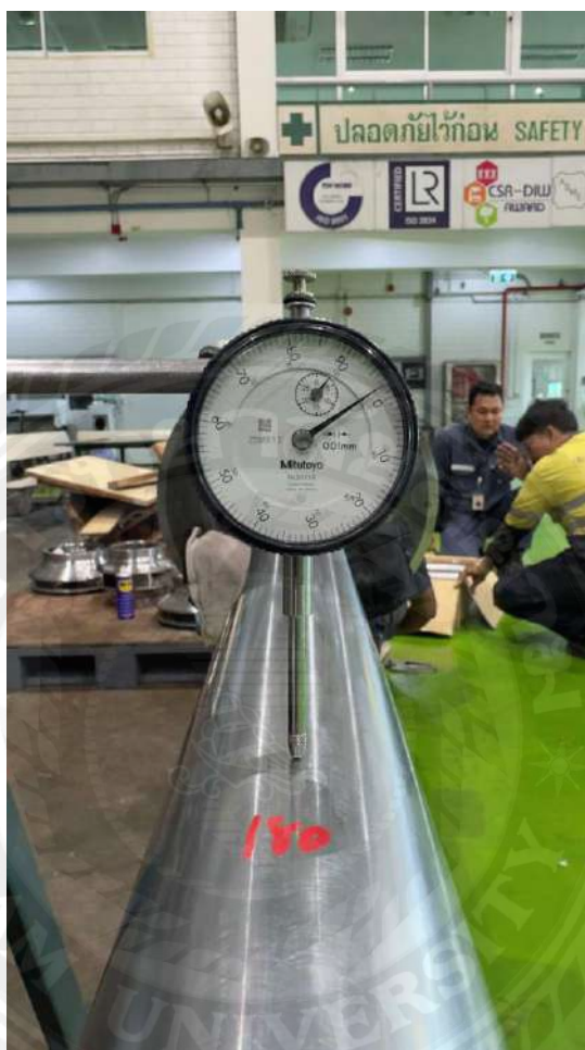
รูปที่ 4.4 ค่าที่ได้ - 0.03 ไม่เกินค่าที่กำหนด
