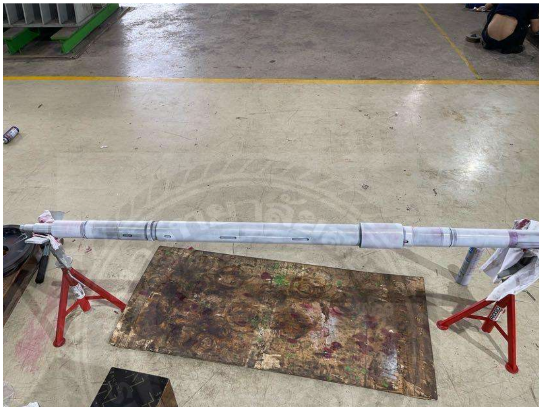
รูปที่ 3.18 ทำการพันสารเคมีขาวเพื่อให้สารเคมีสีแดงถูกสารเคมีสีขาวดูขึ้นมา
