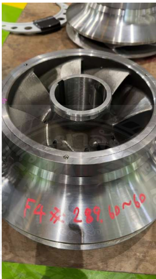
รูปที่ 3.31 ค่าที่ได้ด้านหน้า แนวแกน X Y ใบที่ 4
