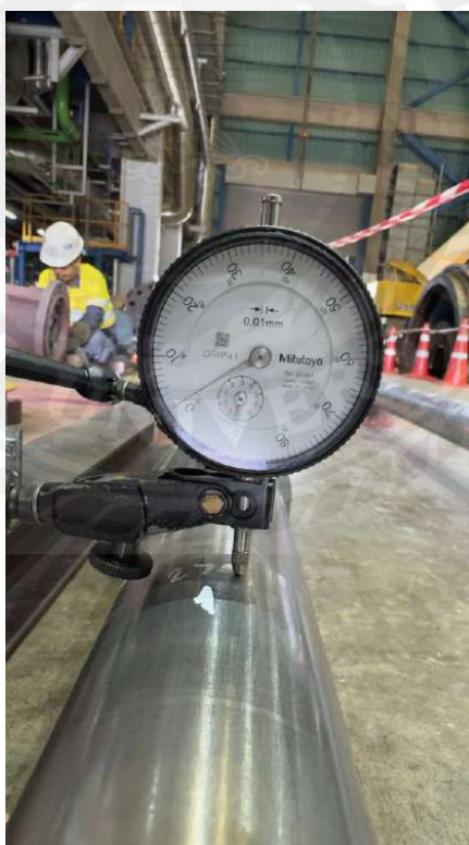
รูปที่ 4.7 ค่าที่ได้ + 0.02 ไม่เกินค่าที่กำหนด
