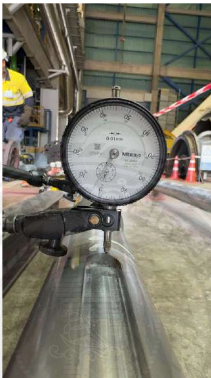
รูปที่ 4.3 ค่าที่ได้ +0.03 ไม่เกินค่าที่กำหนด
