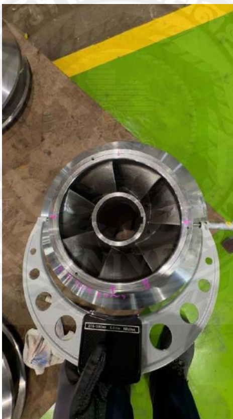
รูปที่ 3.21 การวัดแนว แกน X
