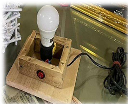
รูปภาพที่ 4.4 ทำฐานหลอดไฟด้วยไม้
