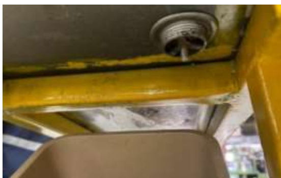
รูปที่ 3.24 ที่ระบายน้ำทิ้งของถังพักน้ำ (ภายนอก)
