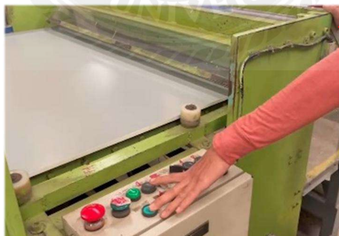
ภาพที่ 4.2 แสดงจุดที่เป็นอันตรายที่สุดของเครื่องพับแผ่นโลหะ : มืออีกข้างของพนักงานมีโอกาสไปวางแล้ว อาจถูกเครื่องจักรหนีบเวลาที่มืออีกข้างกดปุ่มให้เครื่องพับ
