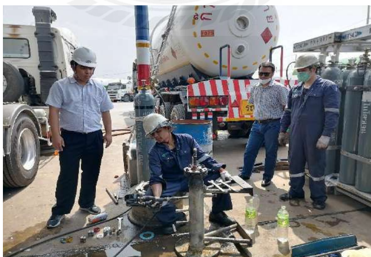
รูปที่ 3.7 การทดสอบการทำงาน Hydro static relief valve
