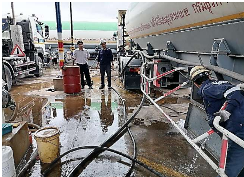
รูปที่ 5.2 การทดสอบการทำงาน Excess flow valve
