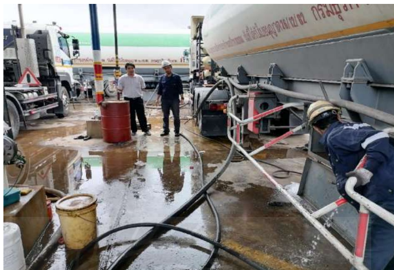
รูปที่ 3.4 การทดสอบการทำงาน Excess Flow Valve
