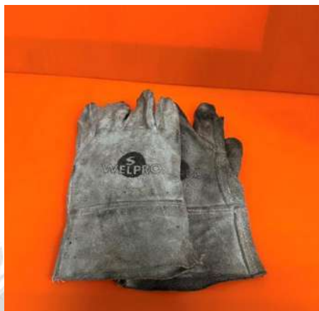
ภาพที่ 2.15 ถุงมือสำหรับงานเชื่อมของพนักงานที่ปฏิบัติงานรื้อถอนเสา
