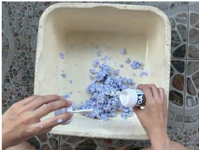
4.3.4 นำกระดาษที่แช่ออกจากน้ำและนำกาวลาเท็กซ์มาผสม และขยำให้เกิดเนื้อเดียวกัน
