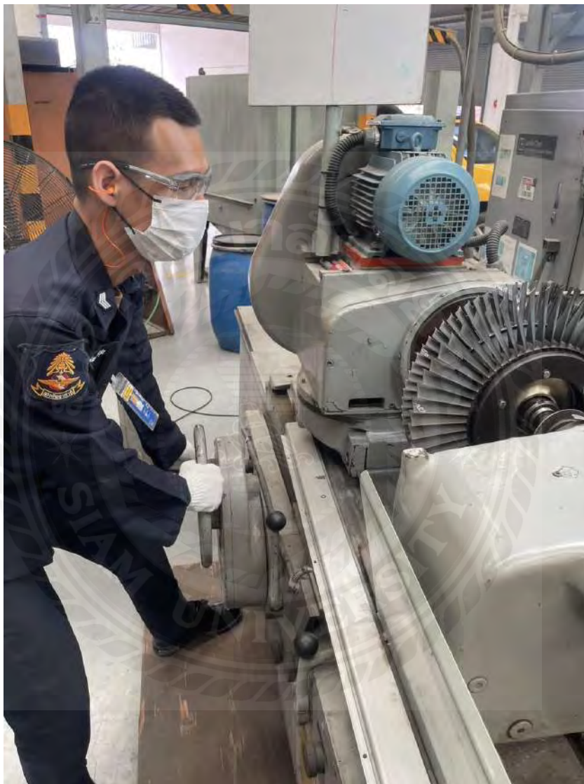
รูปที่ 3.18 การปรับตั้งโต๊ะงานและการ Set Zero
