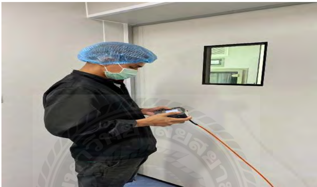
รูปที่ 2.3 การทดสอบแรงดันอากาศภายในห้อง (Room Pressurization Test)
