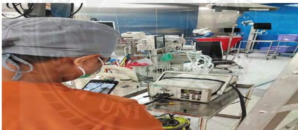
รูปที่ 2.7 การทดสอบการฟื้นตัวของระดับความสะอาดภายในห้อง (Room Recovery Test)
