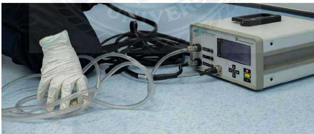
รูปที่ 2.13 อุปกรณ์ตรวจสอบความดันอากาศ (Differential Pressure Meter)
