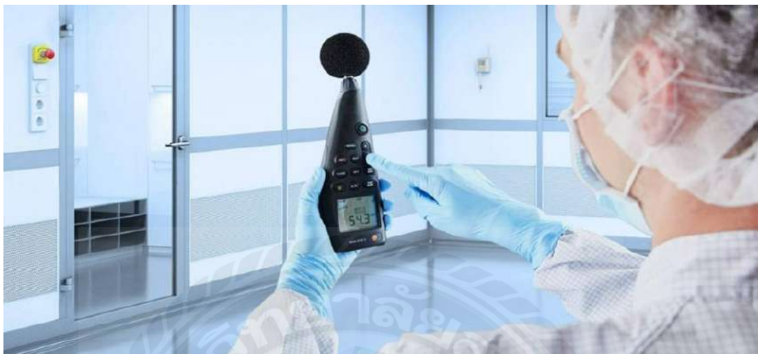
รูป 2.10 การทดสอบระดับเสียงภายในห้อง (Sound Level Test)
