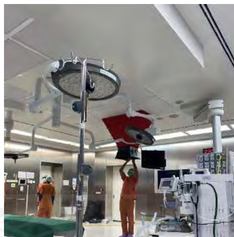
รูปภาคผนวก ที่ 6 วัดอัตราการไหลของอากาศในระบบปรับ อากาศ
