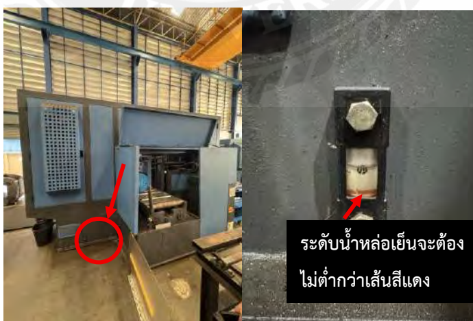
รูปที่ 3.9 เกจวัดระดับน้ำยาหล่อเย็นของเครื่องจักร
