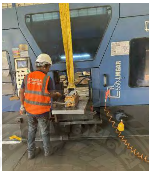
รูปที่ 3.8 การเติมน้ำยาหล่อเย็น
