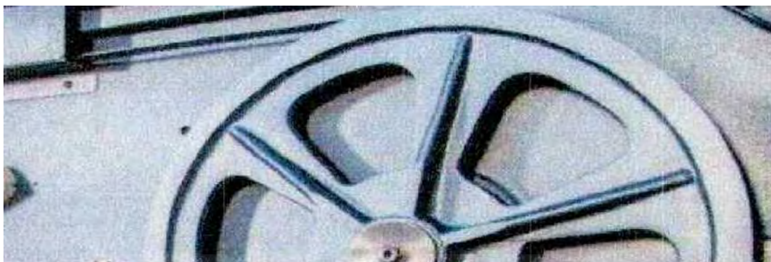
รูปที่ 2.4 ล้อขับสายพานใบเลื่อย
