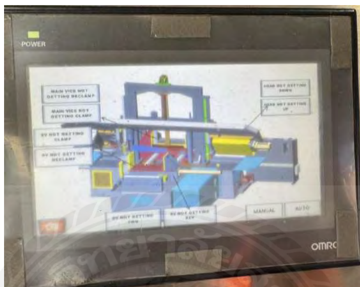
รูปที่ 2.10 หน้าจอแสดงการเตือนเมื่อเกิดความเสียหายภายในของเครื่องจักร
