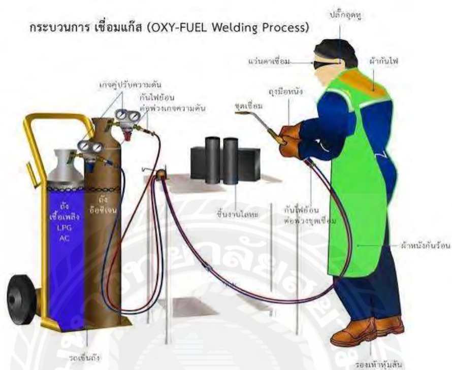
รูปที่ 2.2 กระบวนการเชื่อมด้วยแก๊ส
