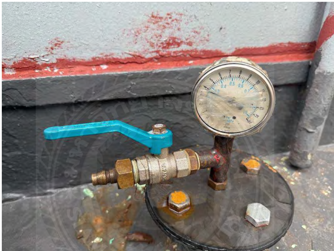
รูปที่ 3.22 เปิดวาล์วเพื่อระบายกำลังดันหลังการทดสอบหารอยรั่ว
