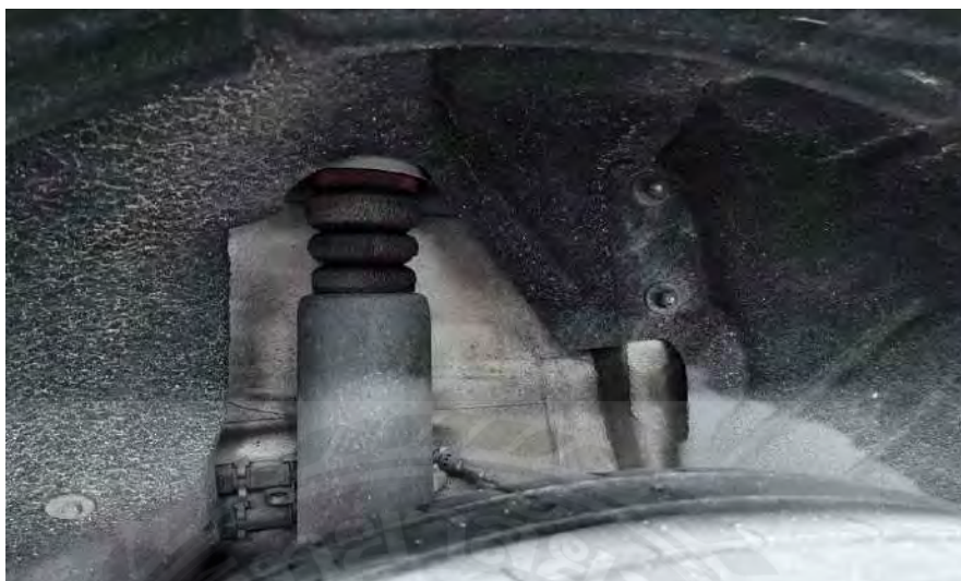
รูปที่ 3.39 การตรวจสอบหลังประกอบโช้คอัพหลัง
