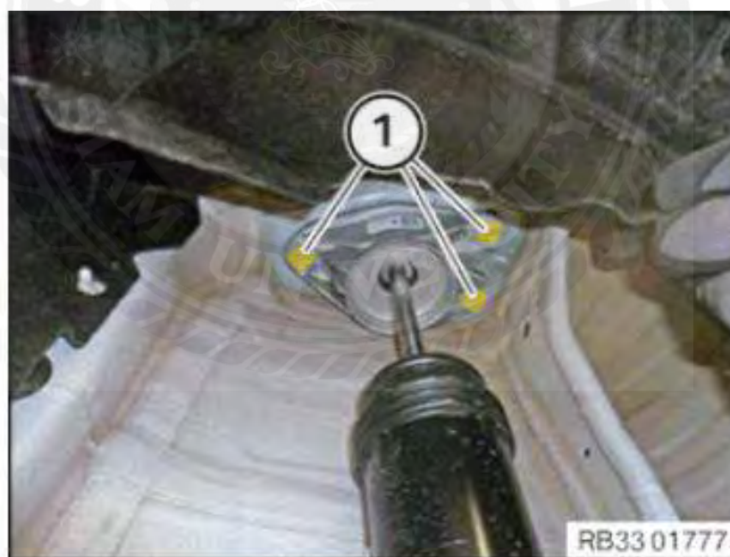
รูปที่ 3.24 การถอดน็อต E12 ที่ยึดออกมีทั้งหมด 3 ตัว
