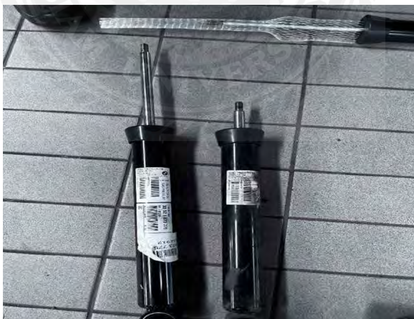
รูปที่ 4.8 การเปรียบเทียบของเก่ากับใหม่ที่มีระยะ 183 mm กับ 55 mm ของโช้คที่เสีย
