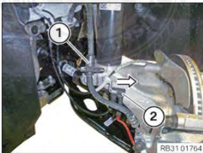
รูปที่ 3.62 การใส่สายท่ออ่อนน้ำมันเบรค
