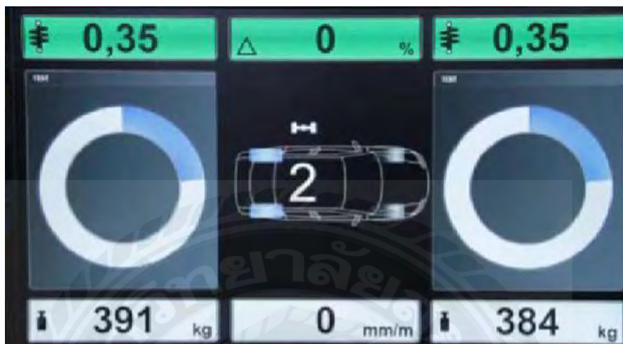
รูปที่ 4.2 ค่าที่วัดได้จากการใช้เครื่องทดสอบโช้คอัพ
