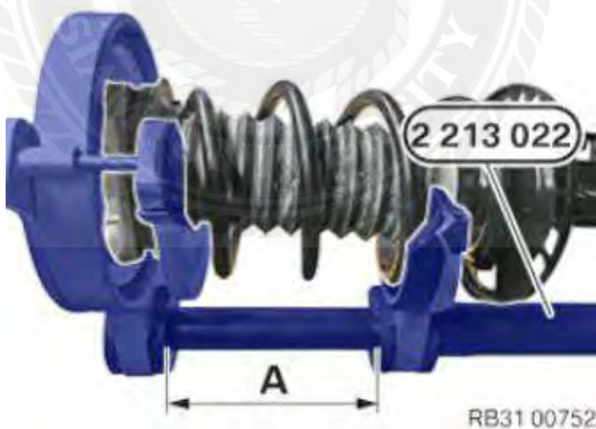
รูปที่ 3.50 การวัดระยะตามในภาพจุด A ระยะ 100 - 125 mm
