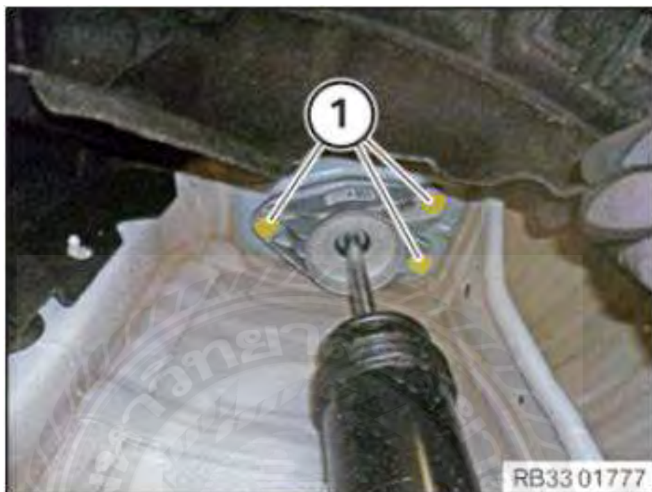
รูปที่ 3.37 การใส่หลอด E12 ที่ยึดมีทั้งหมด 3 ตัว
