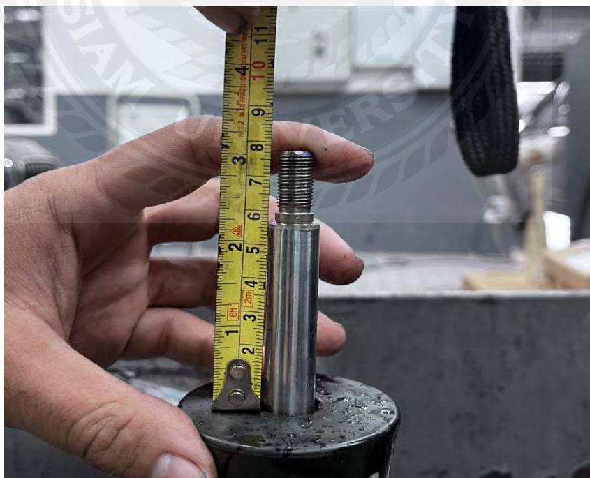
รูปที่ 4.5 อาการความผิดปกติใช้คัพไม่คืนตัววัดได้ 55 mm ตามคู่มือควรมีระยะ 178 mm-183 mm
