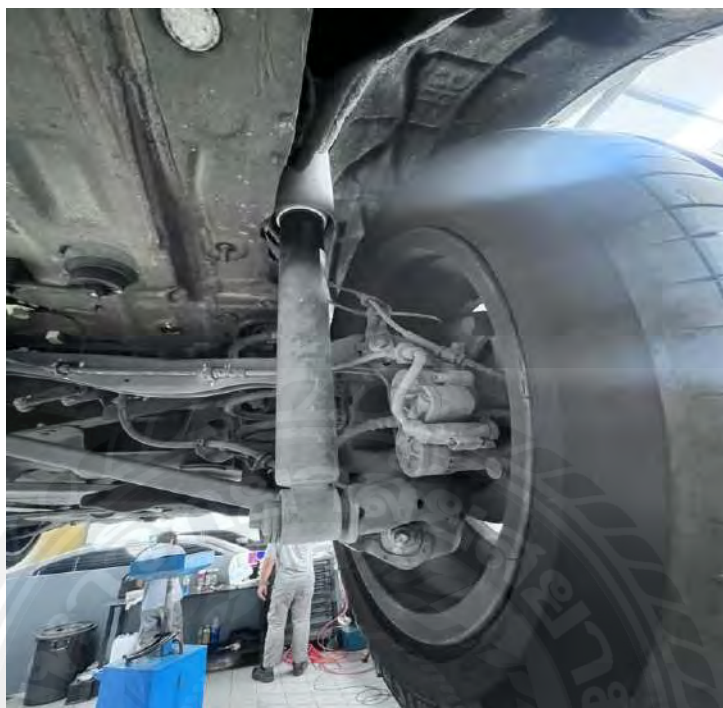
รูปที่ 3.21 โช้คอัพด้านหลังตรวจสอบด้วยสายตาไม่พบคราบน้ำมันรั่วซึม
