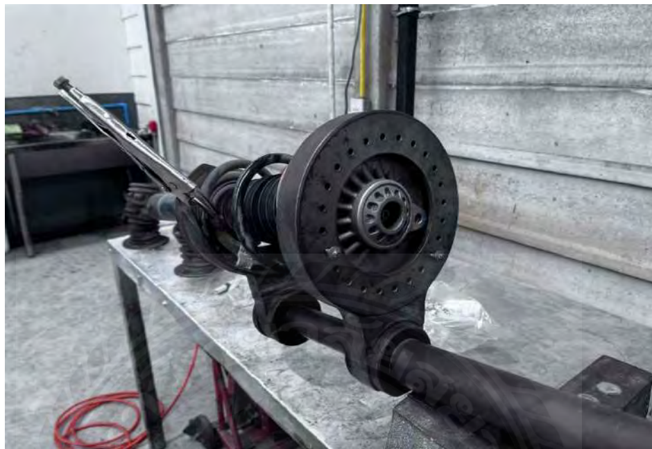
รูปที่ 3.55 หลังทดสอบเสร็จเรียบร้อยประกอบโช้คอัพกลับนำน็อตเบอร์ 18 ยึดกลับที่หัวโช้คอัพ
