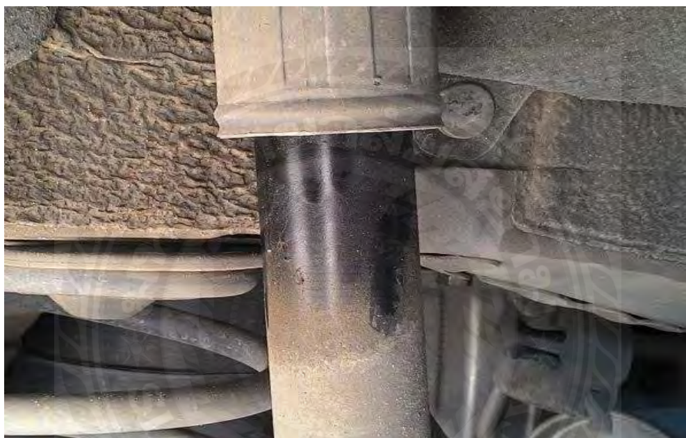
รูปที่ 2.7 โช้คอัพมีคราบน้ำมันรั่วซึมจากการโดนเสื่อมสภาพ
