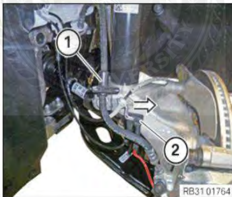
รูปที่ 3.42 การปลดสายท่ออ่อนน้ำมันเบรค
