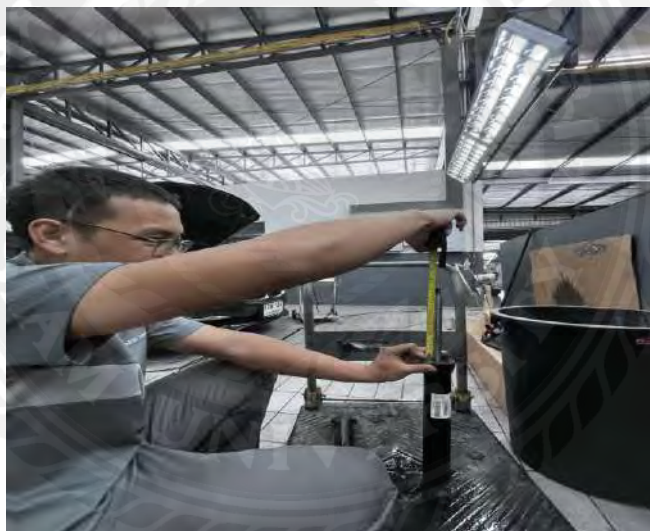
รูปที่ 3.30 การกดใช้คอปที่แกนกลางเพื่อตรวจสอบระยะยุบตัวของโซ่คอปหลังขวา
