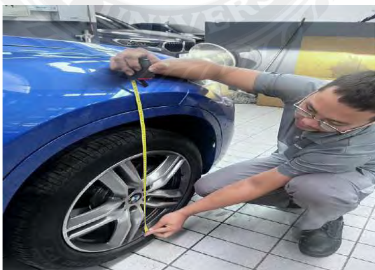
รูปที่ 2.11 วัดเปรียบเทียบความสูงทั้ง 4 ล้อ
