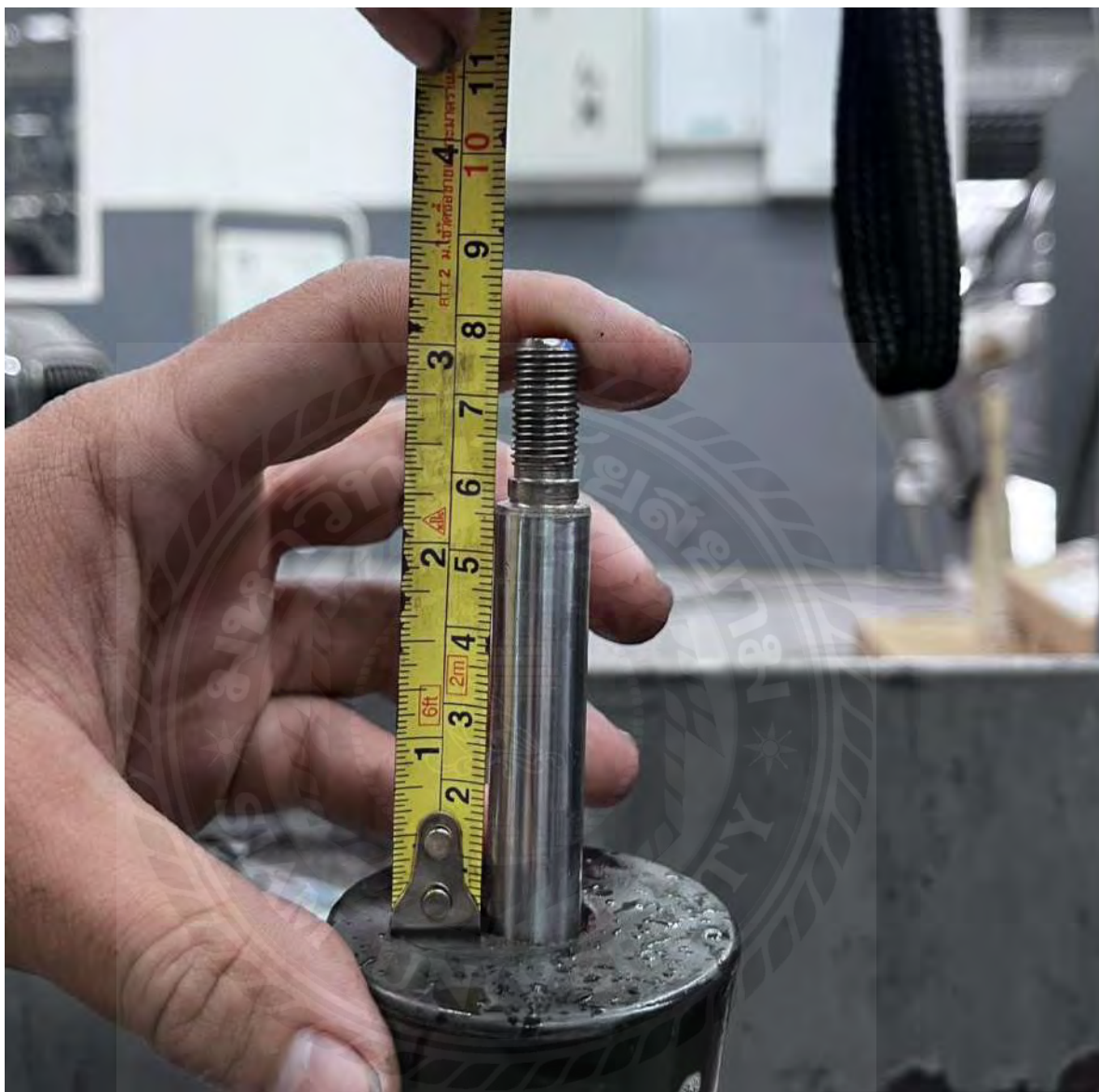
รูปที่ 3.31 ความผิดปกติใช้คอปด้านหลังซ้ายไม้คันทัวและวัดได้ 55 mm ระยะยุบตามคู่มือควรมีระยะ 178 mm – 183 mm
