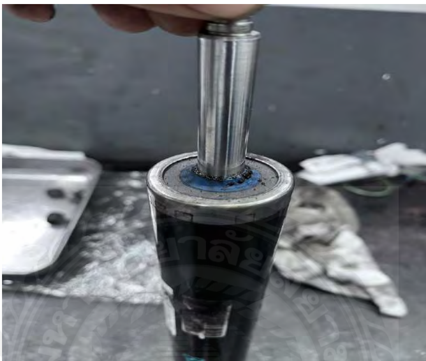
รูปที่ 4.7 การถอดฝาครอบออกพบมีคราบน้ำมันซึมอยู่ภายในโช้คอัพ
