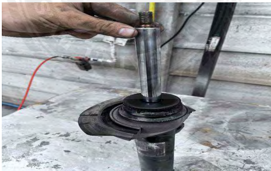
รูปที่ 3.52 การทดสอบโซ่คัพด้วยการกดหัวโซ่คัพลงเพื่อทดสอบการยุบและการยืดของโซ่คัพ
