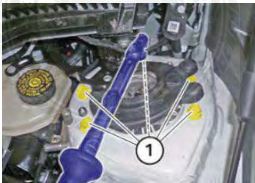
รูปที่ 3.46 การถอดน๊อตยึดหัวโช้คอัพออกทั้งหมด 6 ตัว เบอร์ 13,5 ตัว / เบอร์ 16,1 ตัว
