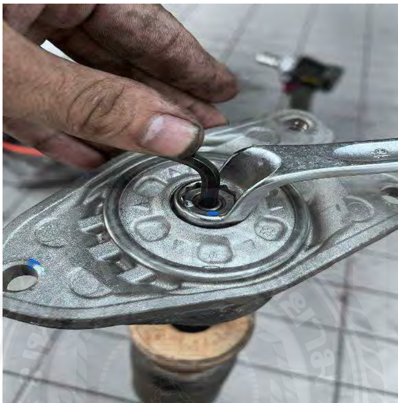
รูปที่ 3.27 การถอดน็อต 16 ที่ยึดหัวโซ่คอปออกด้วยประแจ 16 และคีบด้วย 6 เหลี่ยม
