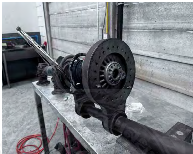
รูปที่ 3.49 การใส่โช้คอัพหน้าเข้ากับที่จับโช้คอัพ
