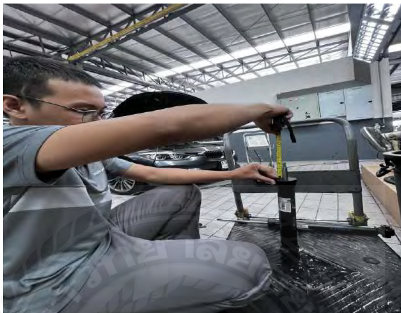
รูปที่ 4.4 หลังพบความผิดปกติของโซ่หลังทำถอดเพื่อทดสอบการกดใช้คัพที่แกนกลางเพื่อดูระยะ ยุบตัว
