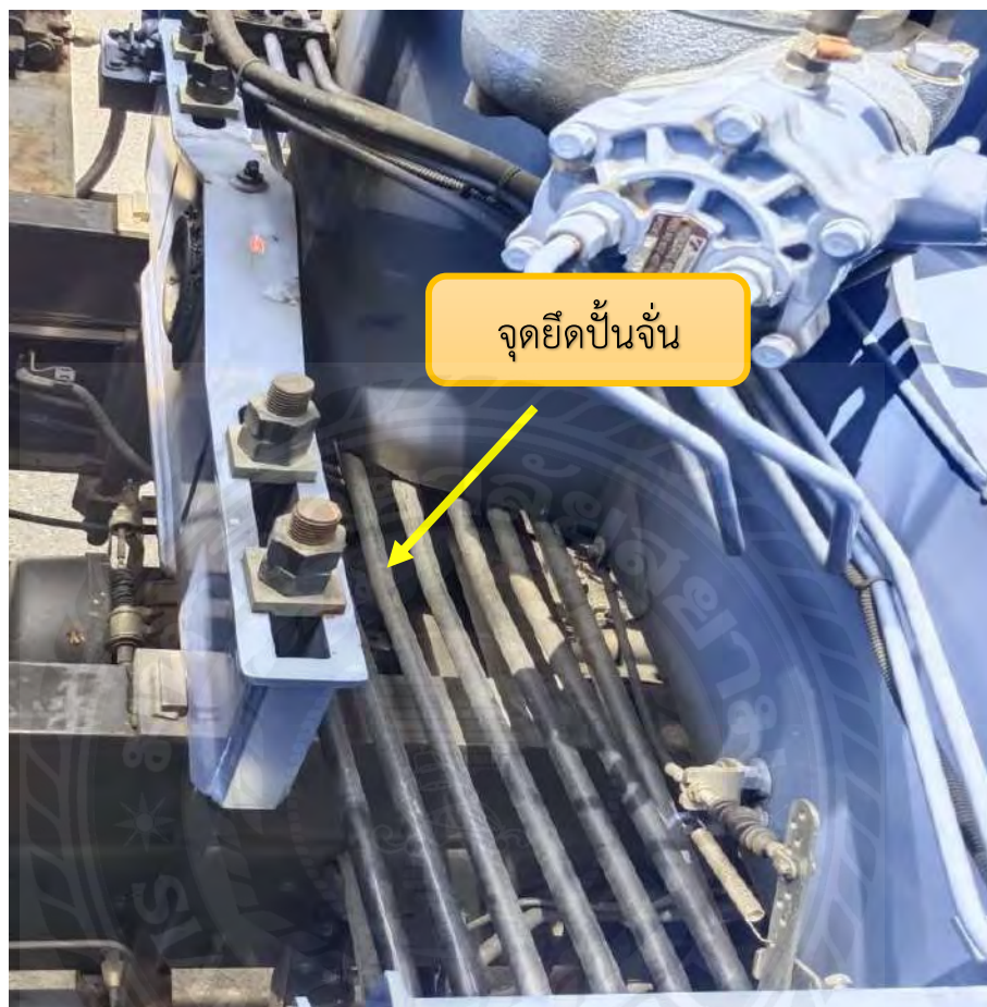
รูปที่ 3.11 ขั้นตอนการตรวจสอบการยึดป็นจันที่ติดตั้งไว้กับตัวรถ
