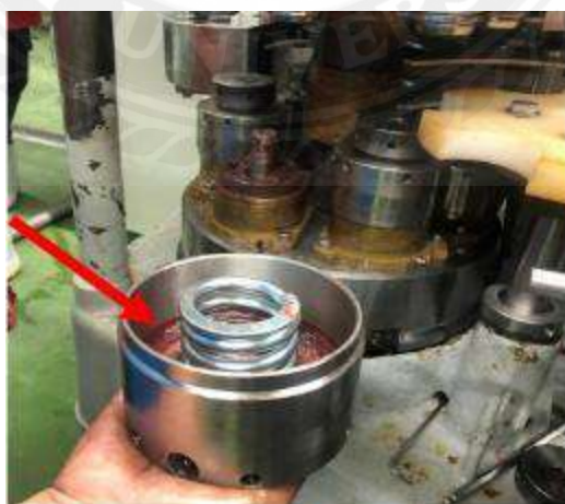
ภาพที่ 3.24 การใส่สารหล่อลื่นเครื่องจักรด้วยตนเอง
