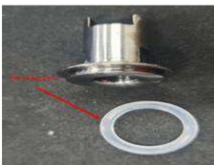
ภาพที่ 3.20 แกนจับฝา (Chuck) ลักษณะเดิมก่อนการปรับปรุง
