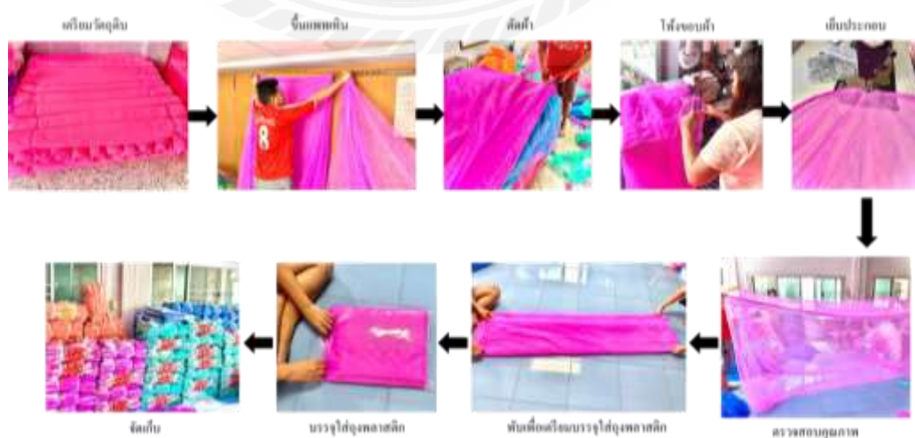
ภาพที่ 3.1 กระบวนการผลิตมุ้ง
