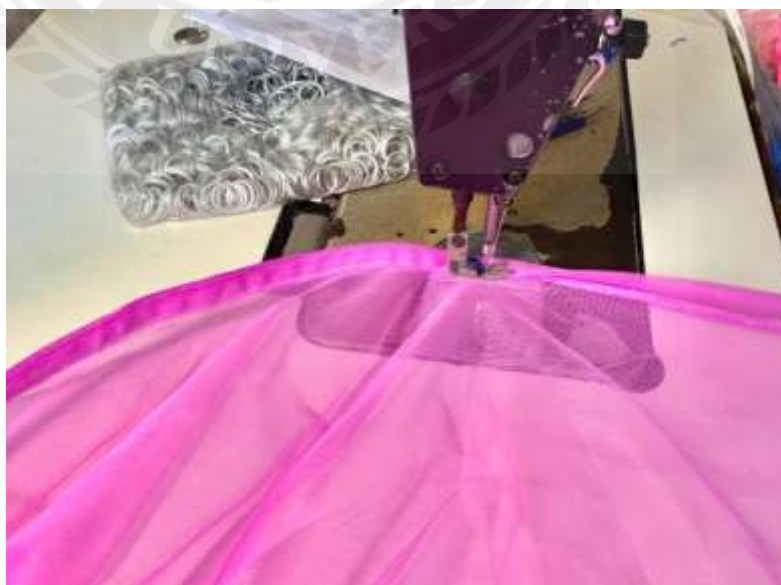
ภาพที่ 2.2 การเย็บประกอบระหว่างตัวมุ้งและเพดานมุ้ง
