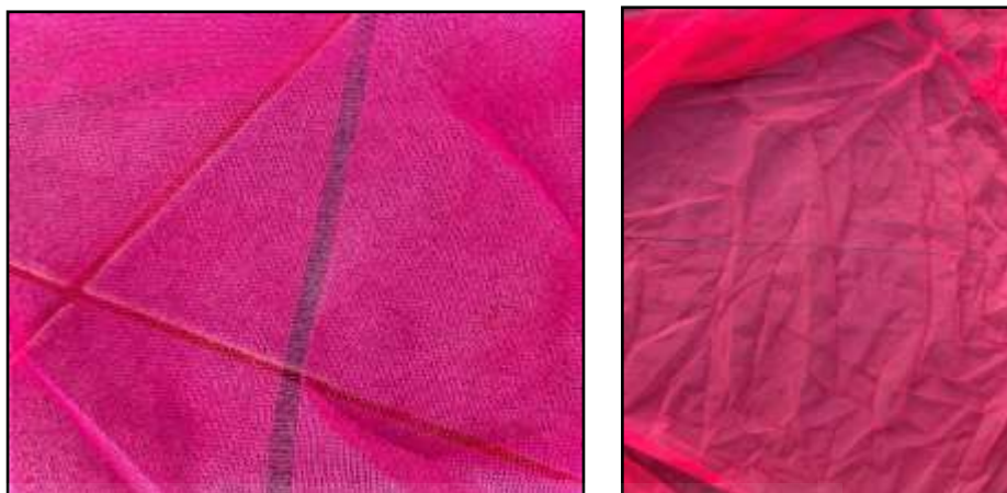
ภาพที่ 3.6 ภาพถ่ายของเสียประเภทผ้าผ้าเป็นเส้น
