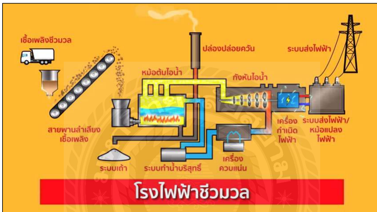
รูปที่ 2.3 แผนภาพกระบวนการทำงานของโรงไฟฟ้าชีวมวลโดยกองทุนพัฒนาไฟฟ้า ที่มา https://pdfmkm.erc.or.th/km_site/CatDetail/266
