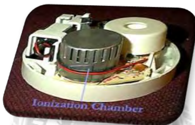
รูปที่ 2.1 ภายในอุปกรณ์ตรวจจับควันชนิด ไอออนเซชัน
