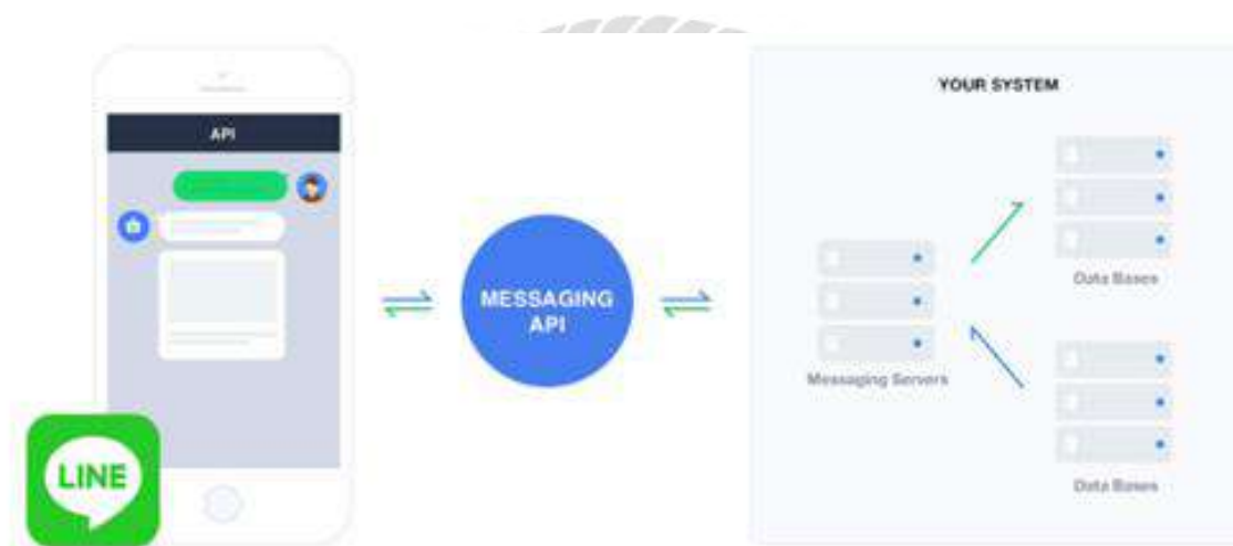
รูปที่ 2.3 การทำงานของ Messaging API
