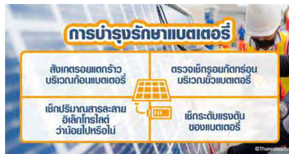
รูปที่ 2.42 การบำรุงรักษาแบตเตอรี่ (ถ้ามี)
