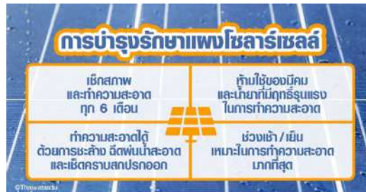
รูปที่ 2.39 การบำรุงรักษาแผงโซลาร์เซลล์ (Solar Panels)
