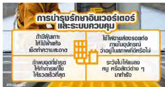
รูปที่ 2.40 การบำรุงรักษาเครื่องอินเวอร์เตอร์และระบบควบคุม
