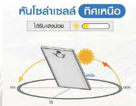
รูปที่ 2.7 การติดตั้งแผงโซลาร์เซลล์ไปทางทิศเหนือ
