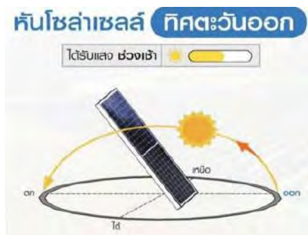
รูปที่ 2.9 การตั้งแผงโซลาร์เซลล์ไปทางทิศตะวันออก
