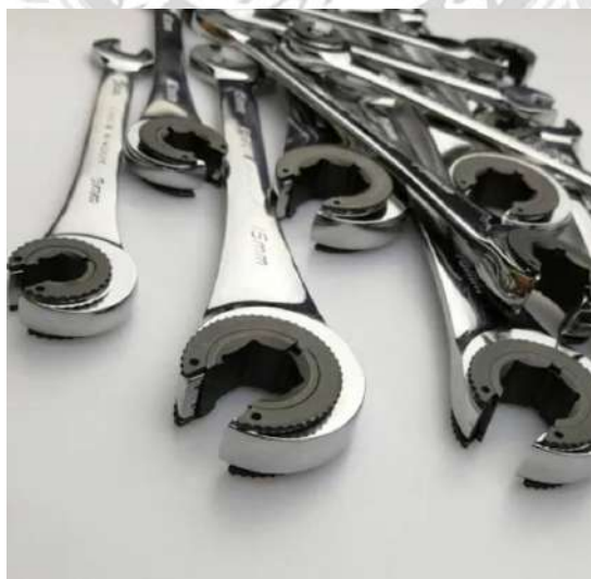
รูปที่ 2.40 ประแจสำหรับข้อต่อท่อแรงดัน (Flare Nut Wrench / Crowfoot Wrench)
