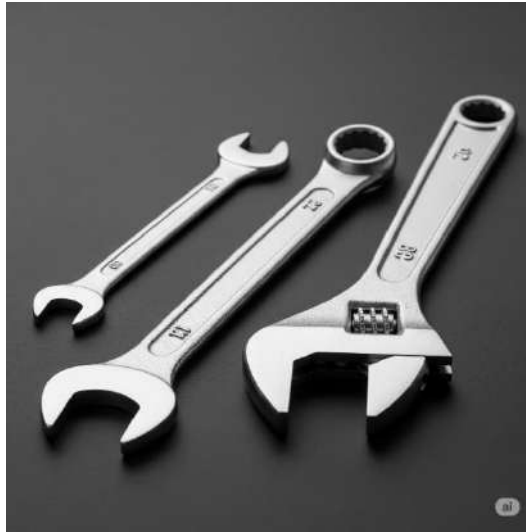
รูปที่ 2.37 ประแจปากตาย / ปากแหวน / ประแจเลื่อน (Wrench/Spanner)
