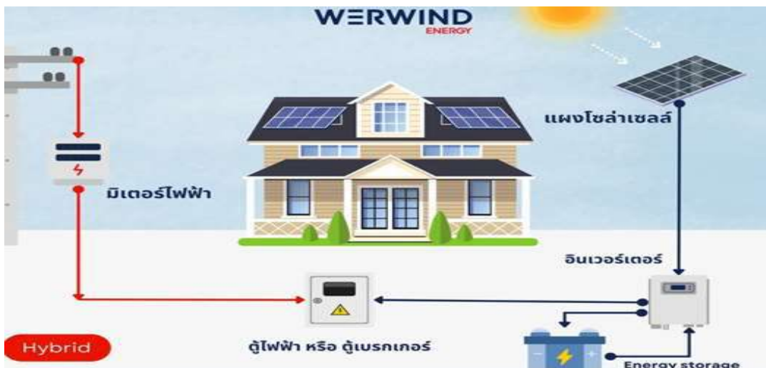
รูปที่ 2.24 การติดตั้งโซลาร์รูฟ
