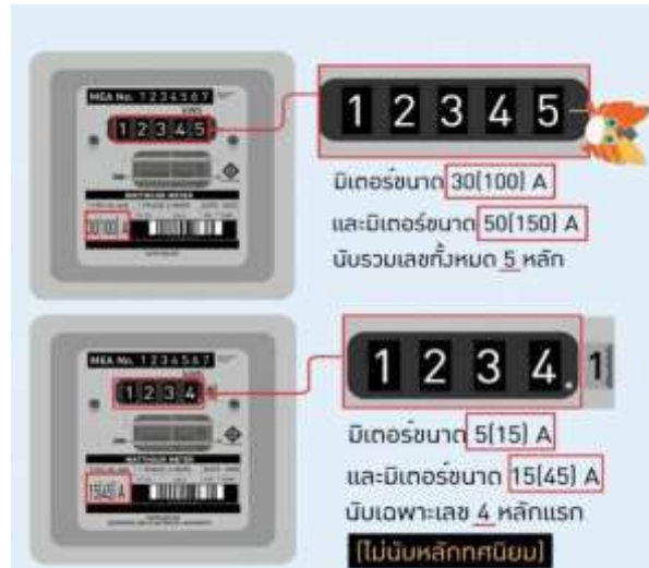
รูปที่ 2.3 การอ่านค่ามิเตอร์ไฟฟ้า
