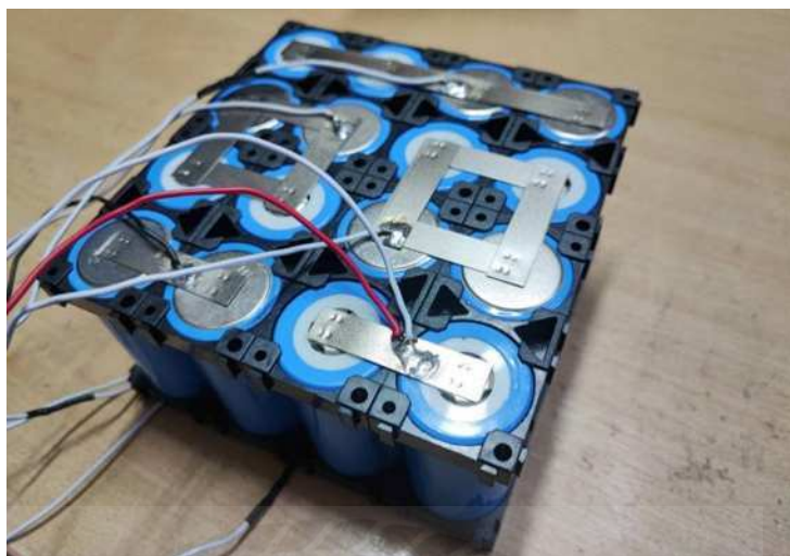
รูปที่ 4.21 ทำการ wiring สาย BMS
