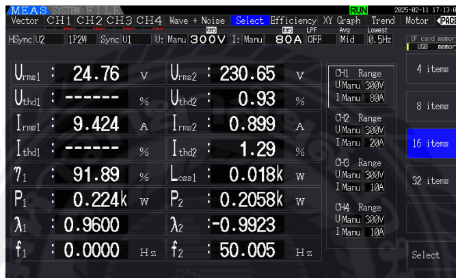
รูปที่ 4.6 ค่าของอินเวอร์เตอร์ 1600W ที่ได้จากเครื่อง Power Analyzer
