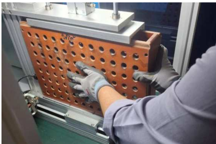
รูปที่ 4.16 นำบล็อกที่ใส่แบตเตอรี่เข้าเครื่องเชื่อมแบตเตอรี่ด้วยจุดสปอต
