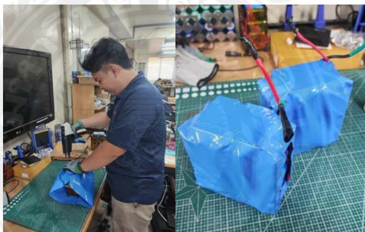
รูปที่ 4.22 หุ้มแบตเตอรี่ด้วยท่อหด PVC
