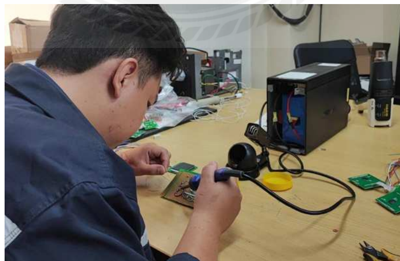
รูปที่ 4.36 ทำการบัดกรีบอร์ดควบคุม
