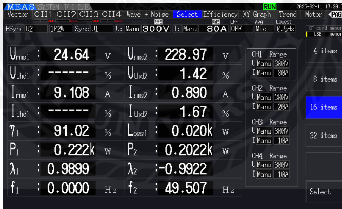
รูปที่ 4.7 ค่าของอินเวอร์เตอร์ 1000W ที่ได้จากเครื่อง Power Analyzer
