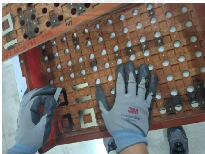
รูปที่ 4.15 จัดเรียงแผ่นนิคเกิลให้เรียบร้อยก่อนวางแบตเตอรี่
