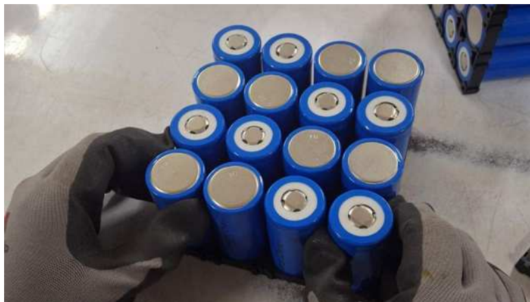
รูปที่ 4.13 การเรียงแบตเตอรี่ในรางใส่แบตเตอรี่
