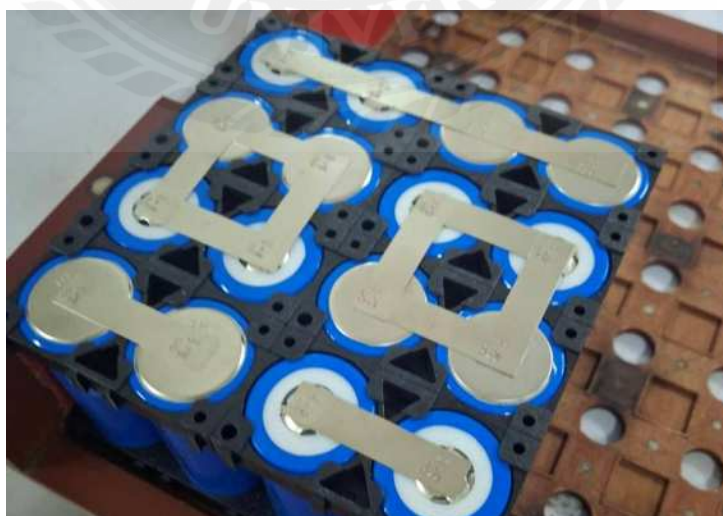
รูปที่ 4.18 ตรวจสอบเทคนิคการเชื่อมแบตเตอรี่ด้วยจุดสปอตแบตเตอรี่ให้เรียบร้อย
