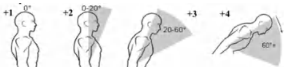
รูปที่ 2.11 แสดงคะแนนการประเมินส่วนลำตัวในวิธี RULA ตารางที่ 2.22 แสดงคะแนนการประเมินส่วนลำตัวในวิธี RULA
