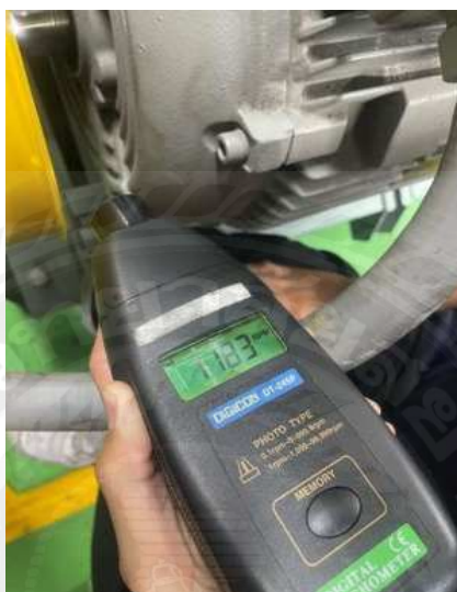
รูปที่ 4.9 การวัดความเร็วรอบของมอเตอร์
