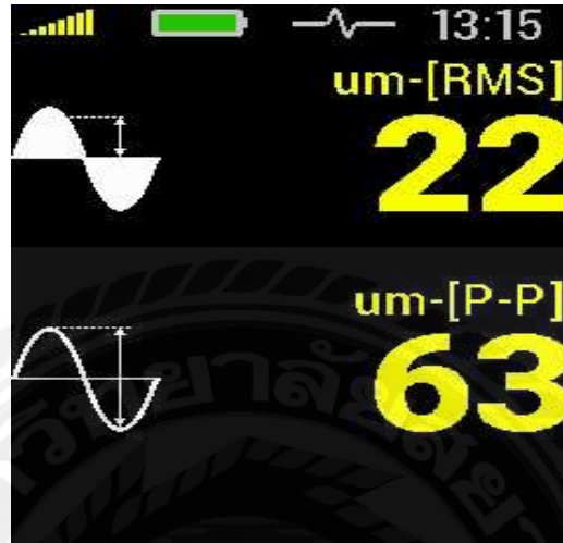
รูปที่ 2.32 หน้าจอโหมด Overall RMS & Peak Displacement
