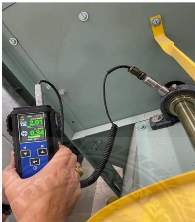
รูปที่ 4.14 พบค่า gE ลูกปืนเริ่มสูงขึ้น
