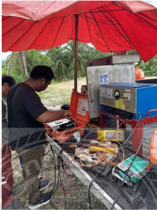
รูปที่ 4.11 ทำการทดสอบระบบการป้องกันการกักร้อนแบบคาโทดิก
