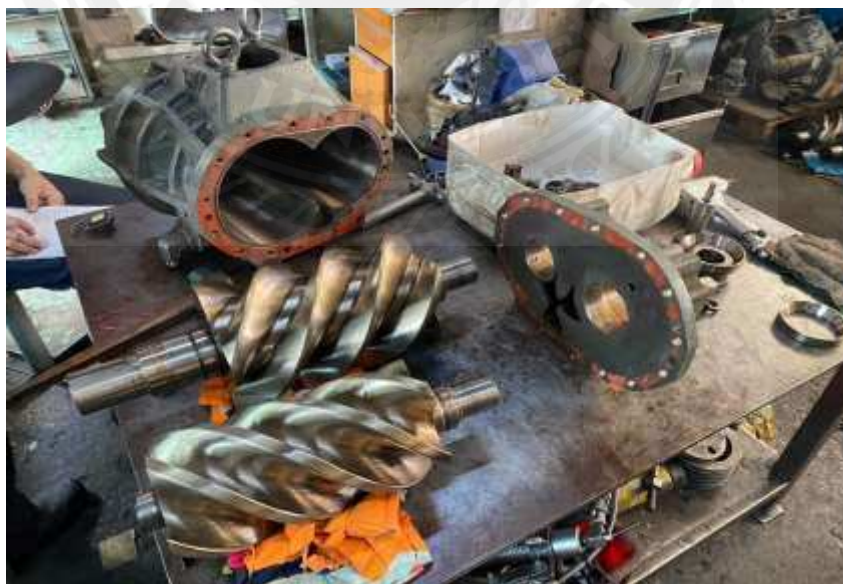
รูปที่ 4.23 ทำการจดยางานเบิกอะไหลที่ตองเปลียน
