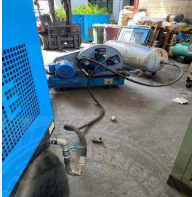
รูปที่ 4.24 ทำการต่อระบบสายลมเข้าปั๊มลม ถึงลม
