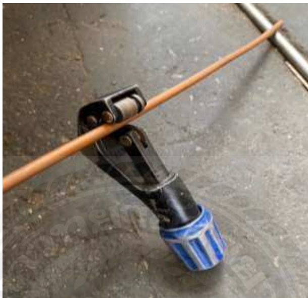
รูปที่ 4.4 ตัดท่อทองแดงด้วยคัตเตอร์ตัดท่อทองแดง
