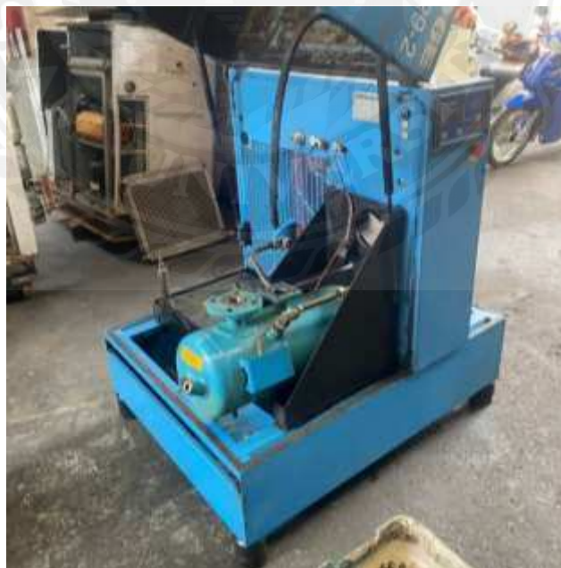
รูปที่ 4.17 ปั๊มลมก่อนติดตั้ง
