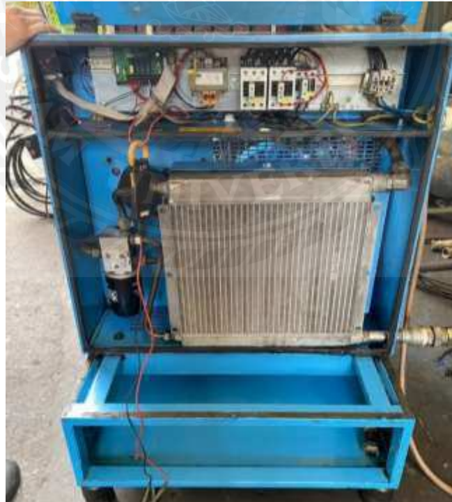
รูปที่ 4.19 ติดตั้งออยล์คูลเลอร์ของปั๊มลม
