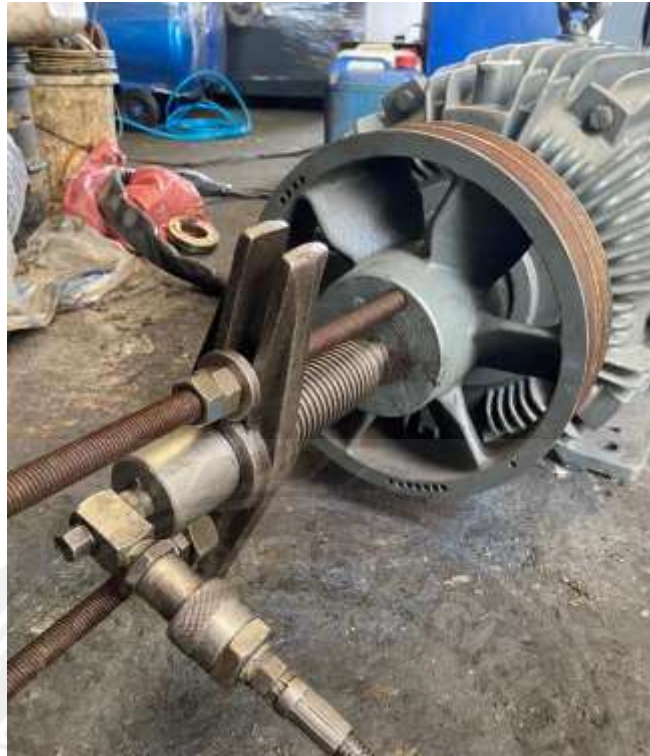
รูปที่ ก 3 การถอดเฟลตามอเตอร์เปลี่ยนลูกปืน
